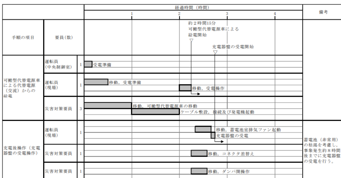
図 2.14-4 可搬型代替電源車による非常用高圧母線 (6-A) 及び非常用高圧母線 (6-B) 受電のタイムチャート*
