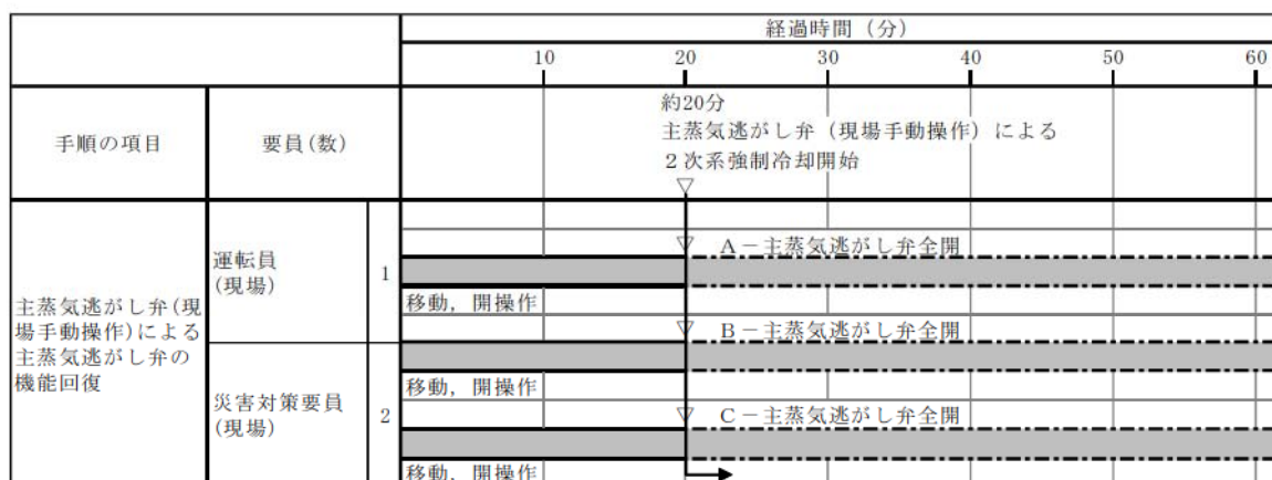
図2.3-5 現場手動操作による主蒸気逃がし弁開放操作 タイムチャート※ 2
