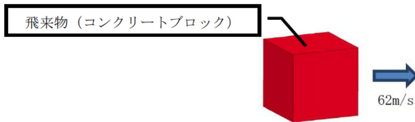
図-2 飛来物（コンクリートブロック）形状
