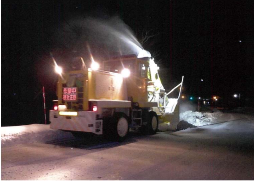
第4図 重機による除雪作業
