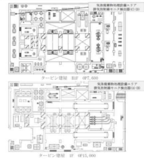
第9-2図：気体廃棄物処理設備エリア排気放射線モニタの配置
