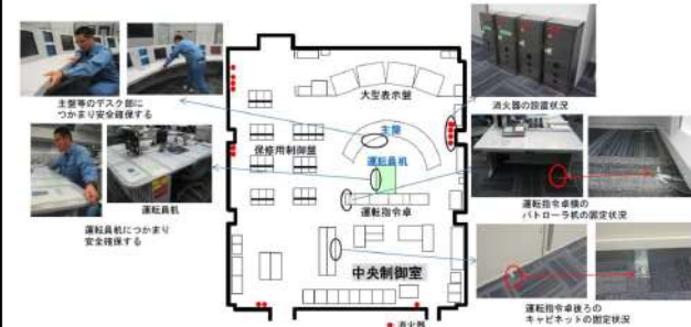
中央制御室における消火器の設置状況及び地震時の対応
