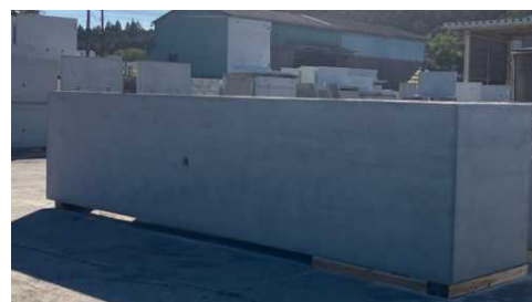
上流水槽側壁
