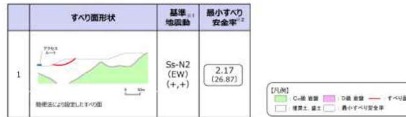
第6.6-3図 グループD（盛土斜面，法尻標高T.P.+88m）の すべり安定性評価結果
