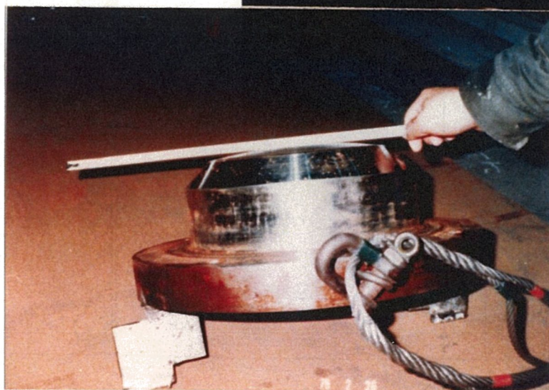
写真 23 落下試験Ⅱ 垂直落下後の下部 蓋の残留変形状況
