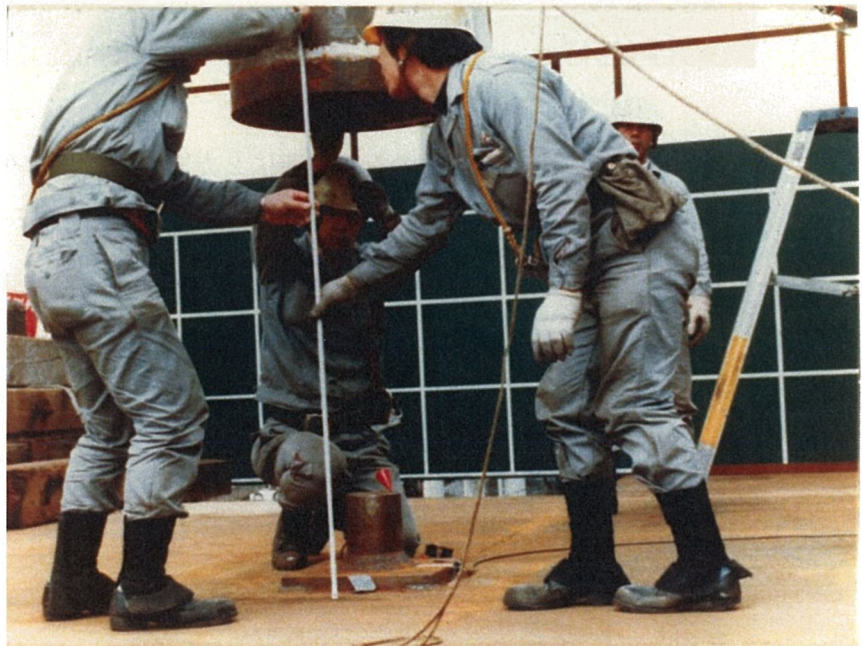
写真9 落下試験Ⅱ 輸送容器落下高さ測定状況 (垂直落下)
