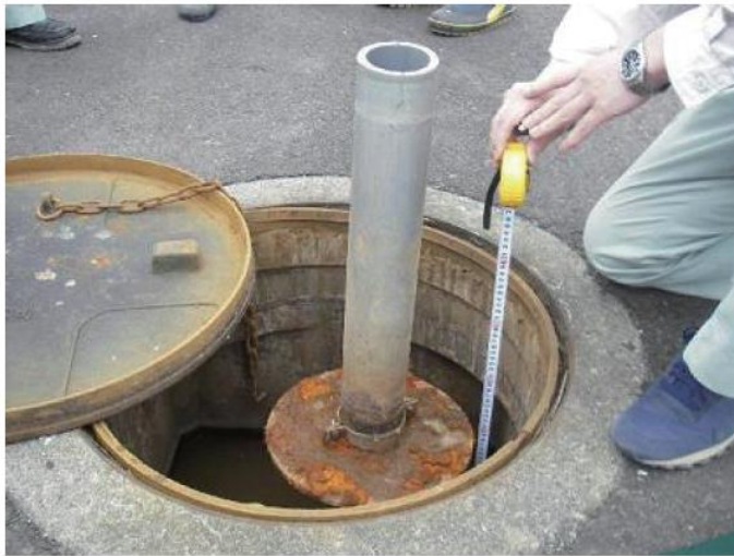
写真-5.22 堤体の沈下により約40cm突出した層別沈下計のパイプ
