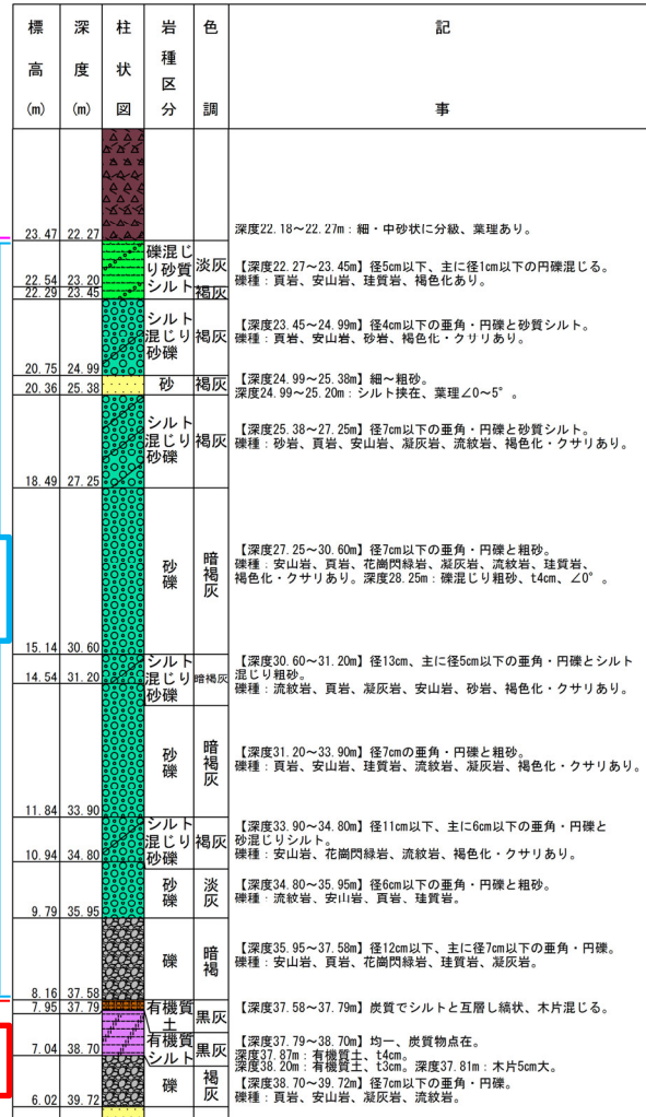
ボーリング柱状図 (深度20~40m)
