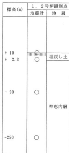
地震計の設置レベル
