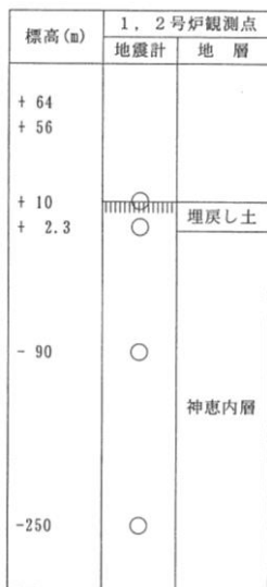
地震計の設置レベル
