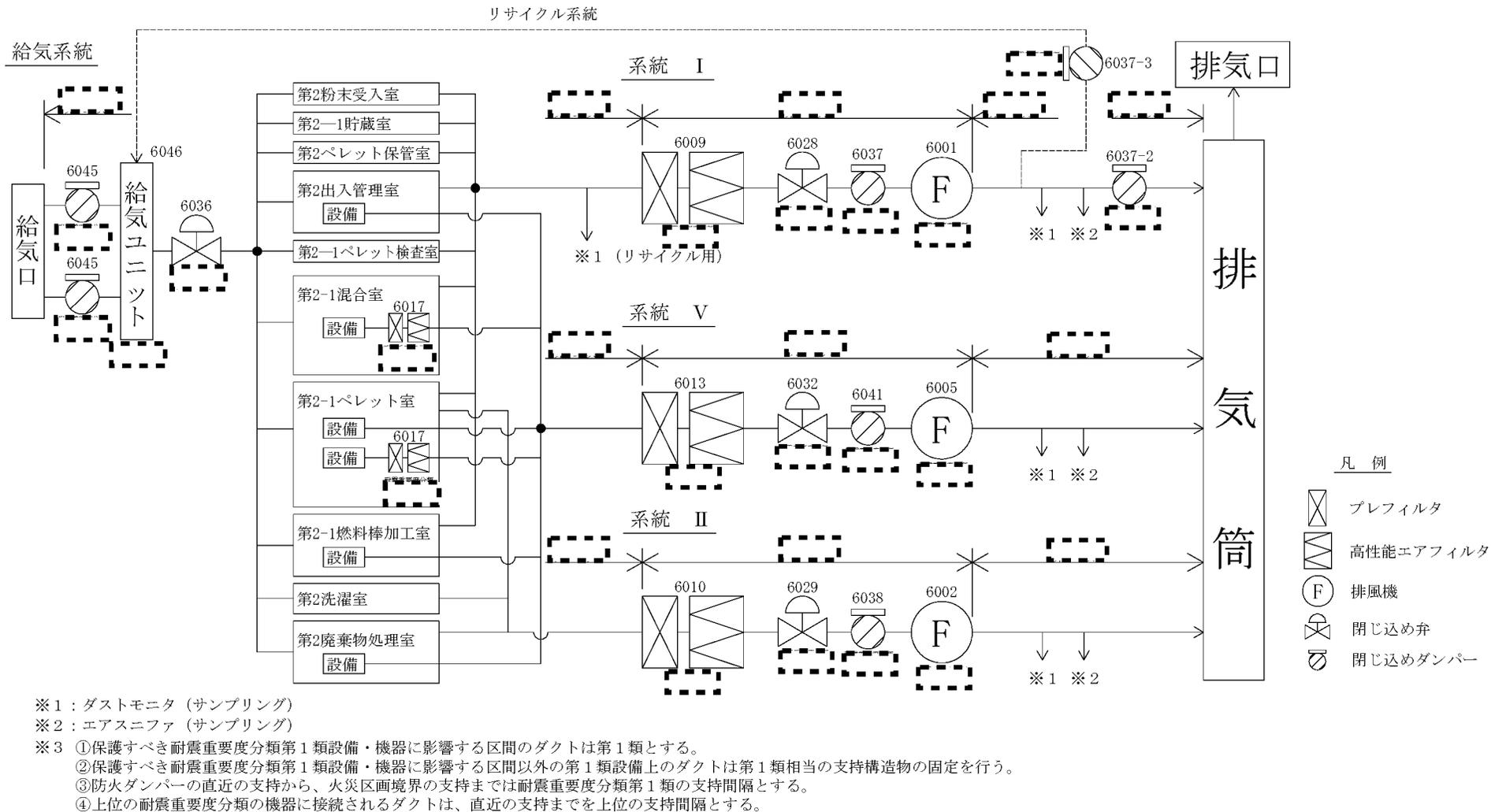
図トー2P設-2-1-1(1) 気体廃棄設備 No.1 (系統 I、系統 II、系統 V、給気系統) の設備及び機器の配置詳細図 (系統図)
