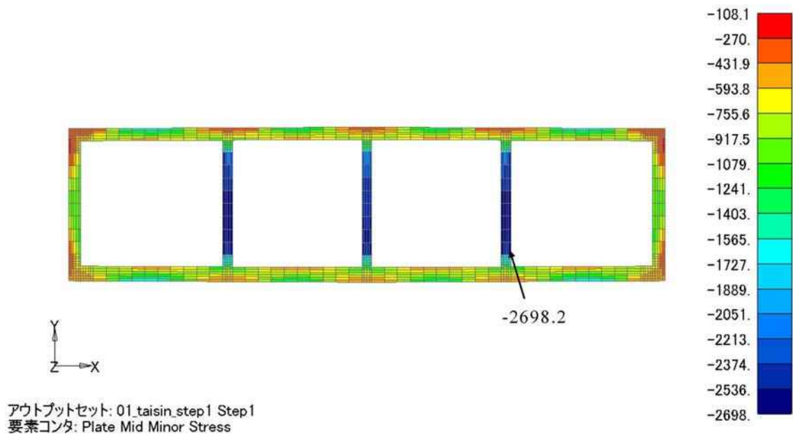
図 1-イ (ハ)-21 解析結果(圧縮応力照査：覆土後 常時、単位：kN/m 2 )
