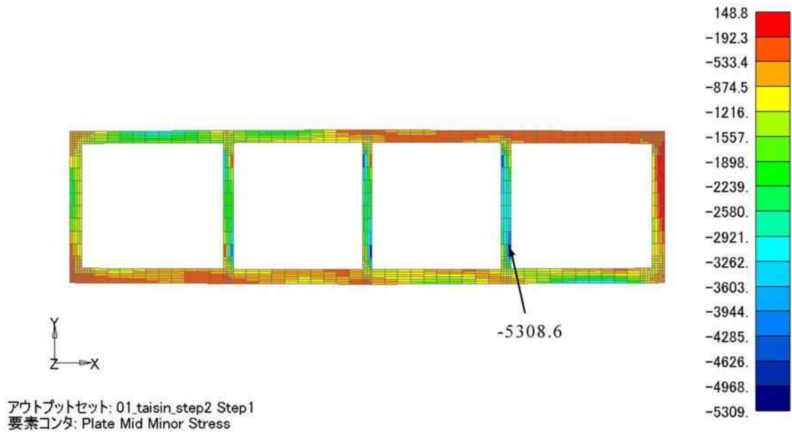
図 1-イ (ハ)-22 解析結果(圧縮応力照査：覆土後 地震時、単位：kN/m 2 )
