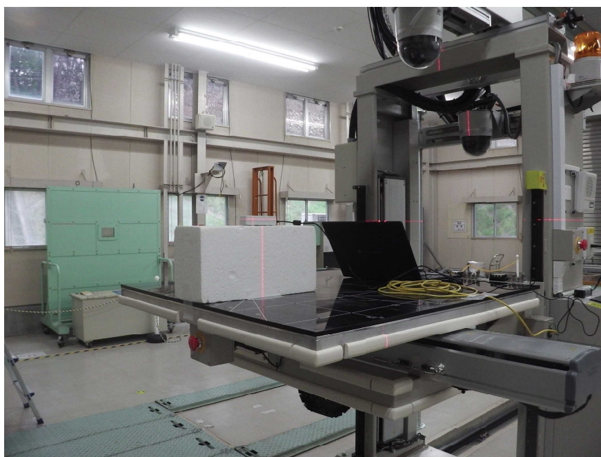
図 24 核燃料サイクル工学研究所での照射の様子。検出器は中央発泡スチロールの上に設置されており、計測制御用の PC は検出器後方に置かれている。
