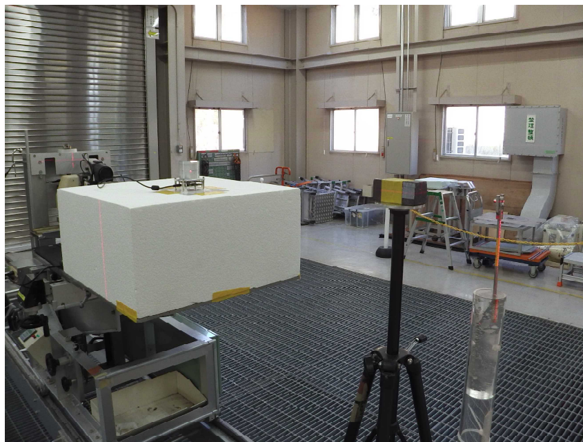
図 20 エネルギー特性試験の様子。線源と検出器の間に鉛遮蔽体を置いた状態でも測定し、直接線以外の影響を差し引いた。
