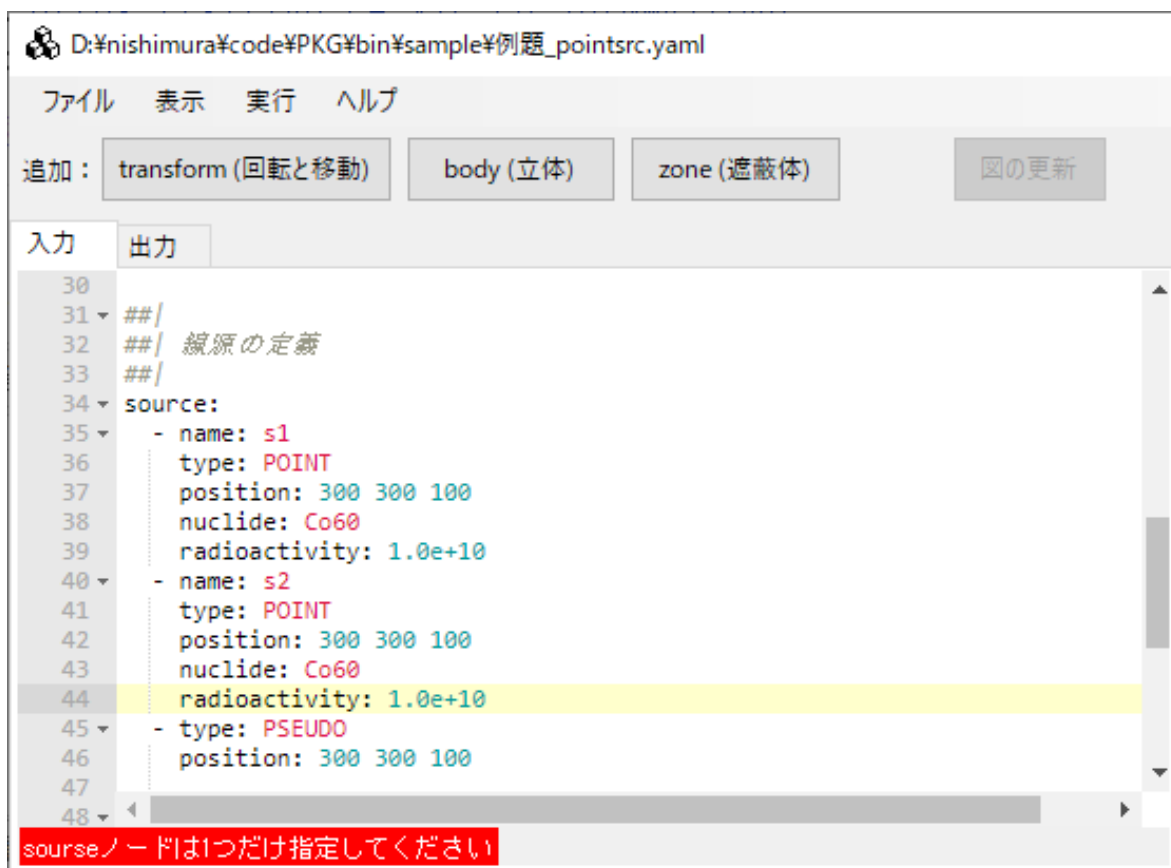
図 4-24 従来コードにおける複数線源定義時のエラーメッセージ
