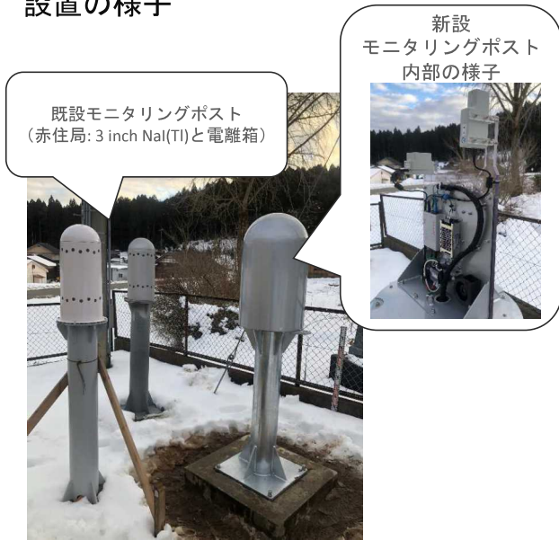
石川県導入の高線量率用検出器で試験 既存モニタリングポストに隣接して設置
