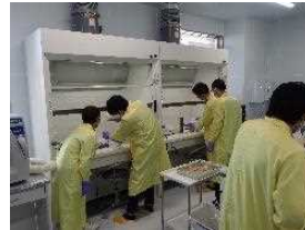
尿試料の前処理工程(湿式灰化)
