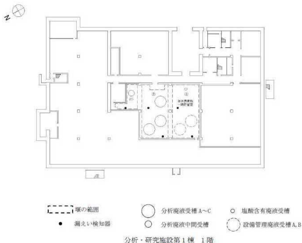
図-1 液体廃棄物一時貯留設備 堰を明示した図
