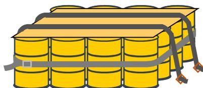
添図 5 - 1 - 3 平積み時の固縛対策 (固縛及び固定)
