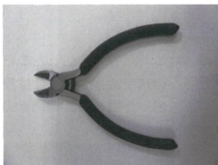
写真 10 未使用の NRA 封印ワイヤーの切断に使用した一般的なニッパ
