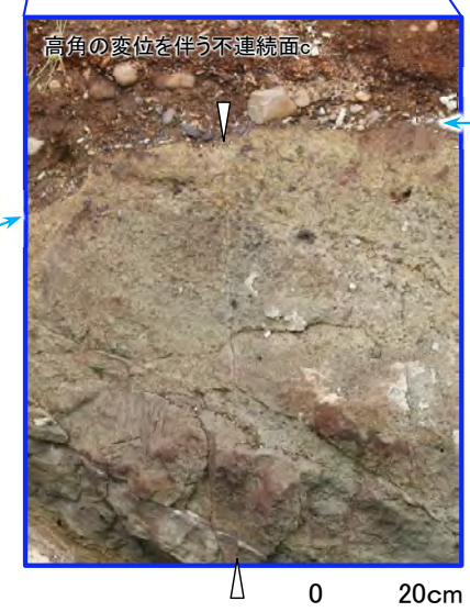
高角の変位を伴う不連続面c • 走向・傾斜:N46° E, 84° N • M 3 面段丘堆積物に変位・変形を与えていない。
