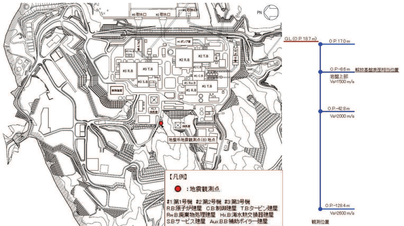
図4-5 女川原子力発電所における地震観測点の位置
