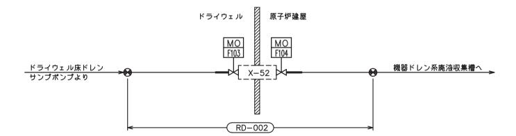
放射性ドレン移送系概略系統図
