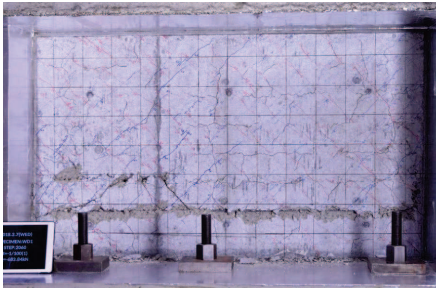
図 4-2 乾燥試験体 [2] 最終破壊時写真
