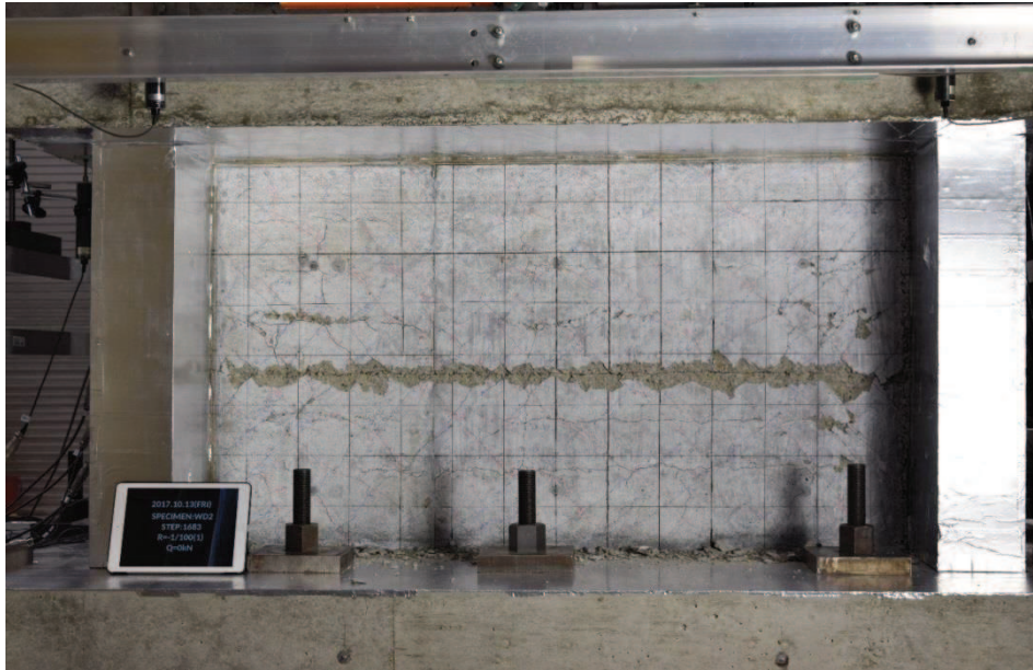
図 3-2 乾燥試験体 [1] 最終破壊時写真
