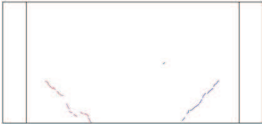
図 3-4(1) 1/5000rad.におけるひび割れ図
