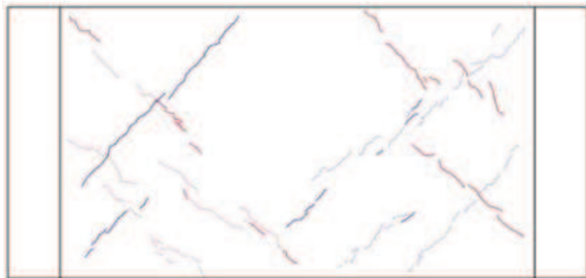
図 3-4(3) 1/2500rad.におけるひび割れ図
