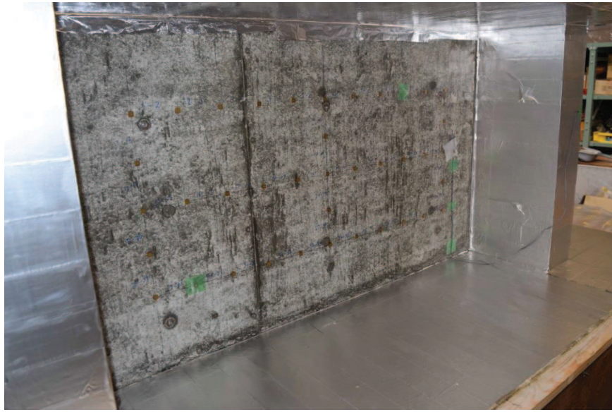
図 2-5 乾燥試験体 [1] [2] 養生状況
