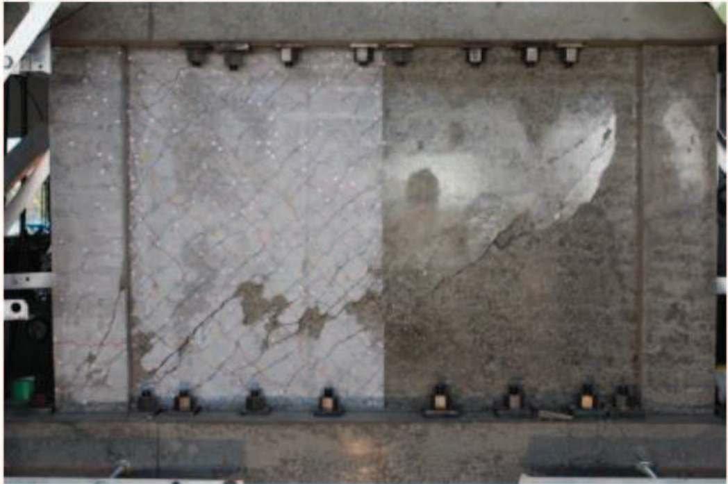
図 3-2 試験体 S-13-D0 最終破壊時写真
