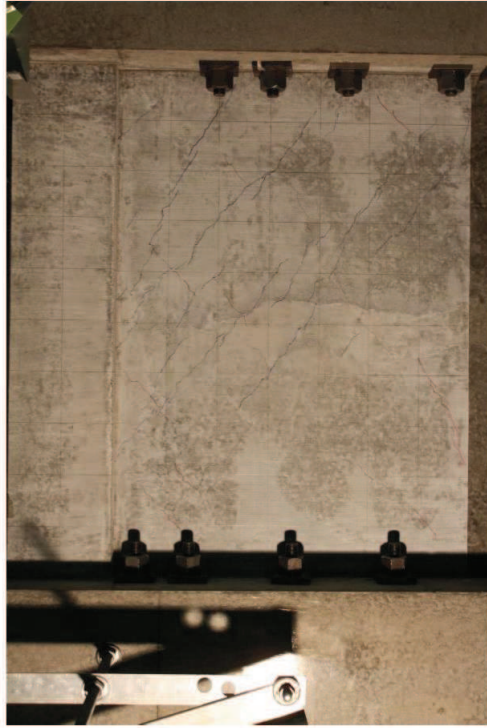
図 3-9 試験体 S-13-D I 事前加力終了時 (0.75/1000rad.) 写真
