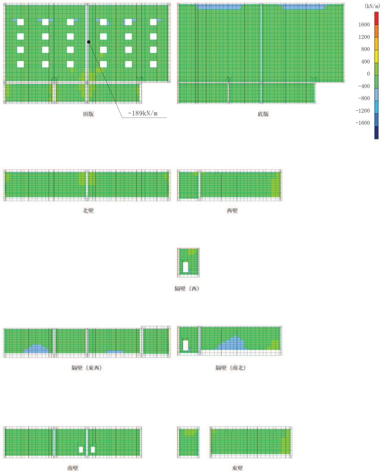
図 10-4 静的地震力載荷時の断面力分布図 (軸力 (kN/m) : N_y )
