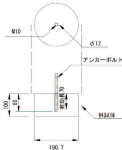
図4-1 供試体の形状
