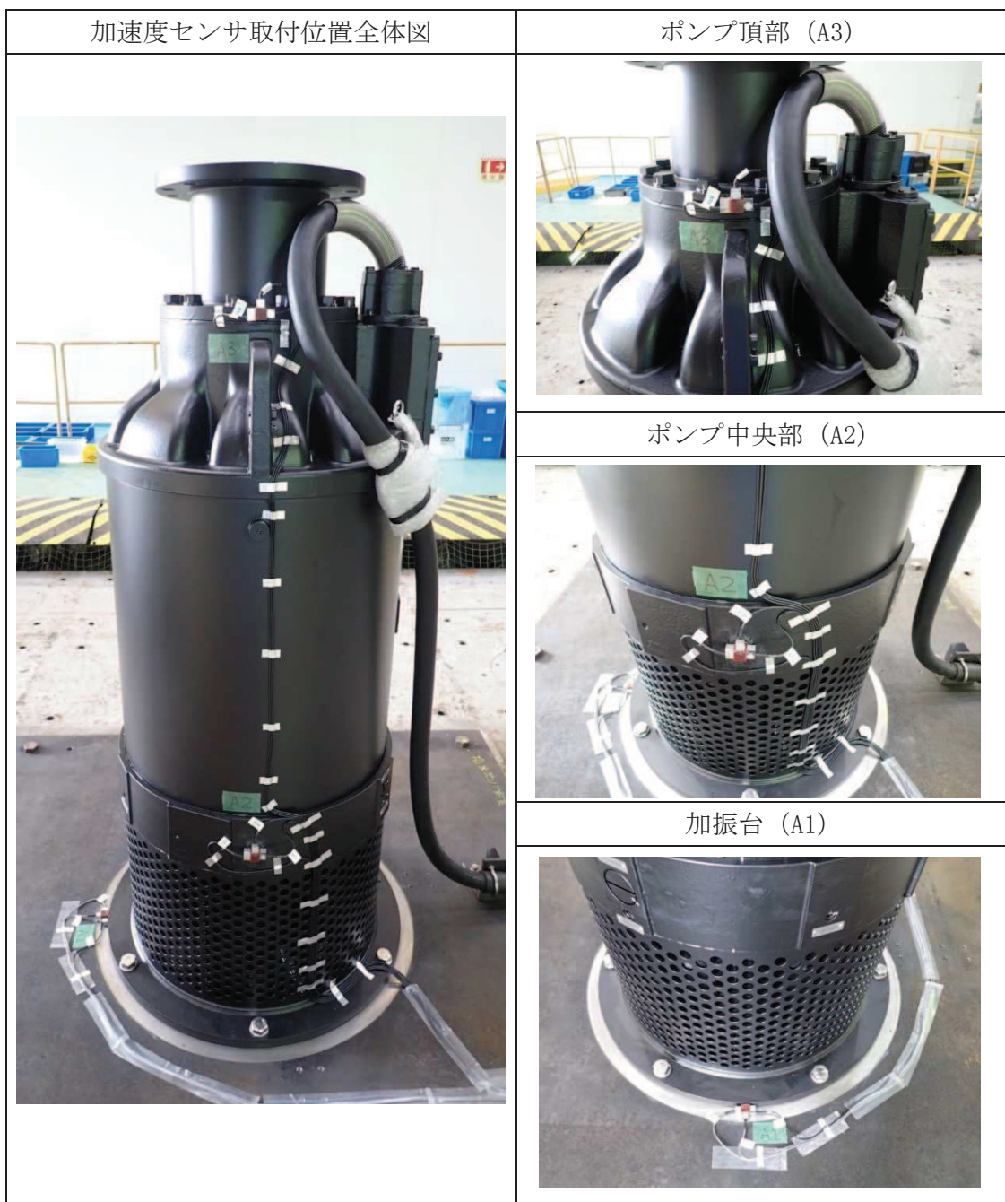
図 3-1(b) 加速度センサ取付位置 (水平 Y 方向+鉛直方向加振試験)
