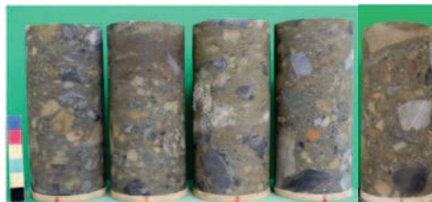
液状化強度試験供試体 (A-2 : 試験前)
