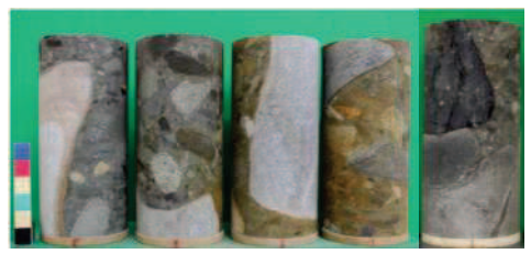
液状化強度試験供試体 (A-7-2 : 試験前)
