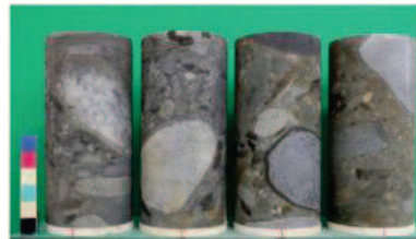
液状化強度試験供試体 (A-6 : 試験前)
