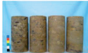
液状化強度試験供試体 (A-4 : 試験前)
