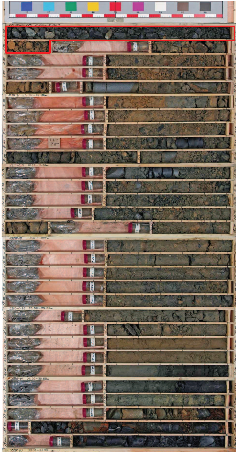
図 1-13(2) ボーリングコア写真 (25BW-10) (盛土：深度 0～22.35m, 旧表土：深度 22.35～27.88m)
