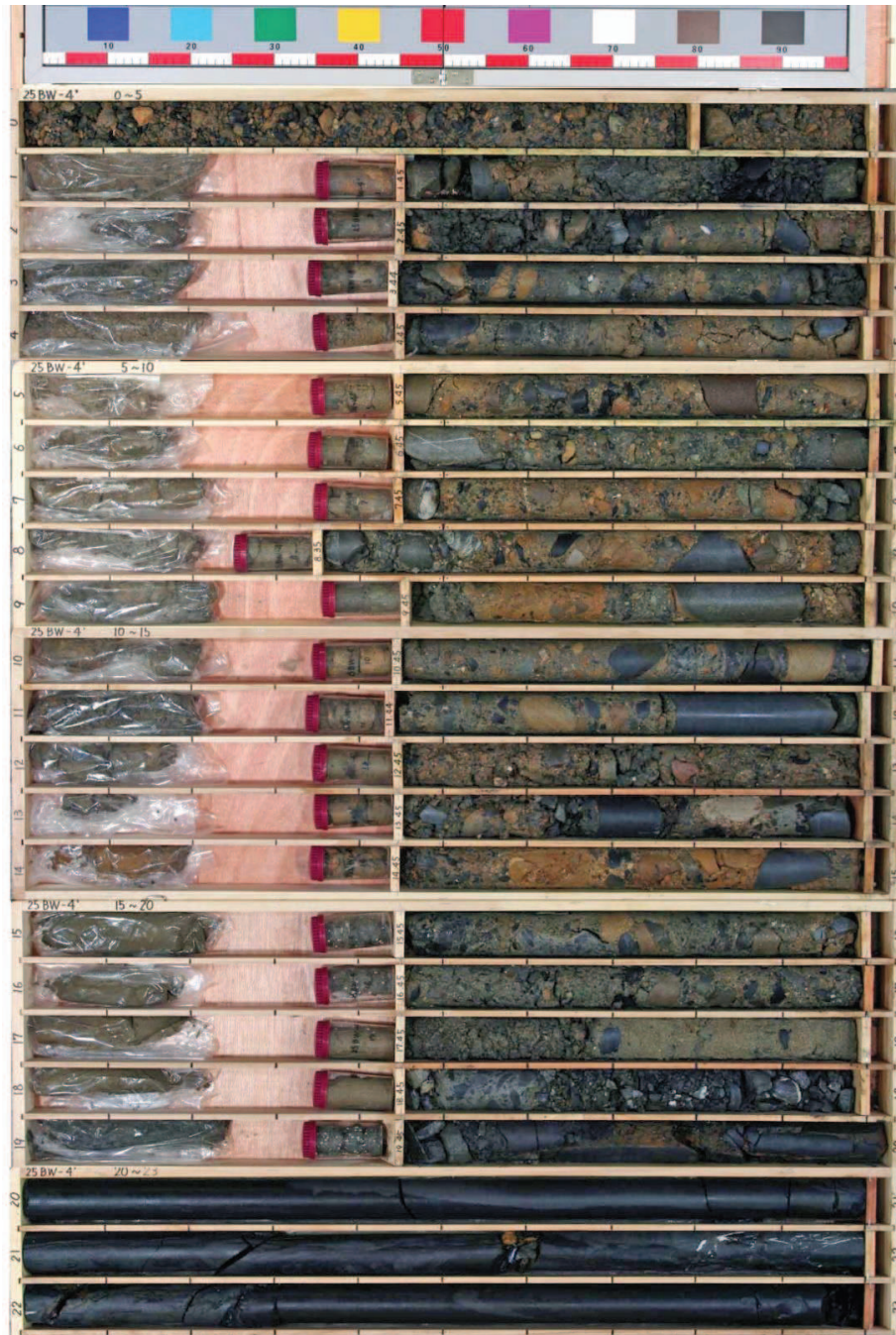
図 1-7(2) ボーリングコア写真 (25BW-4) (盛土: 深度 0~19.57m)
