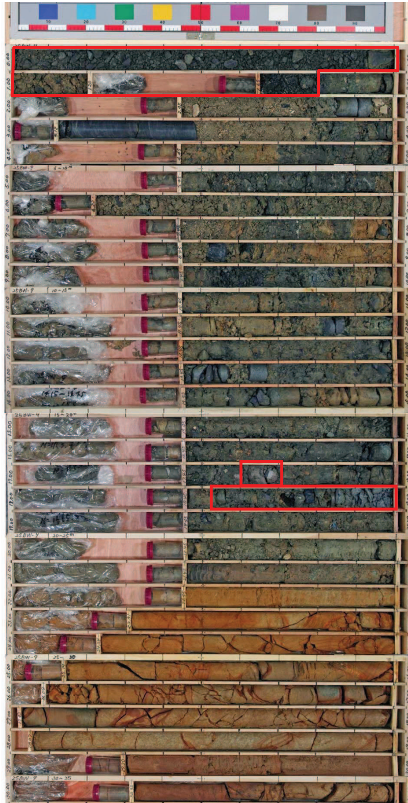
図 1-12(2) ボーリングコア写真 (25BW-9) (盛土 : 深度 0~20.73m, 旧表土 : 深度 20.73~22.35m)
