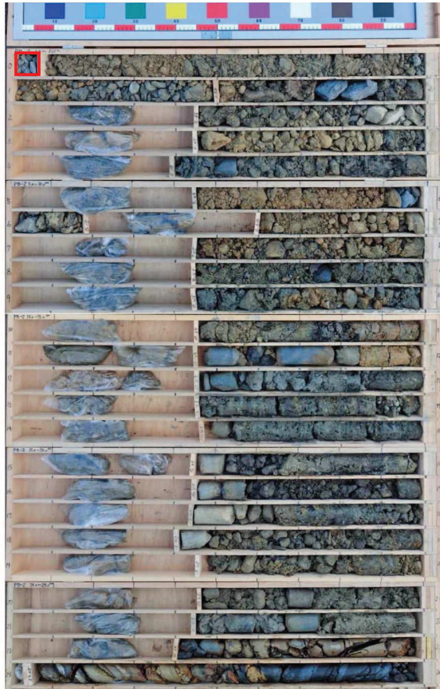
図 1-3(2) ボーリングコア写真 (PB-2) (盛土：深度 0～22.38m)
