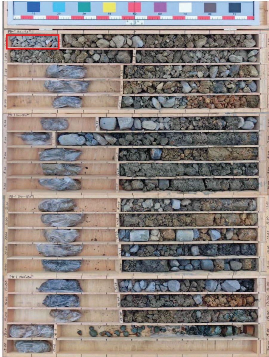
図 1-2(2) ボーリングコア写真 (PB-1) (盛土：深度 0～17.90m)
