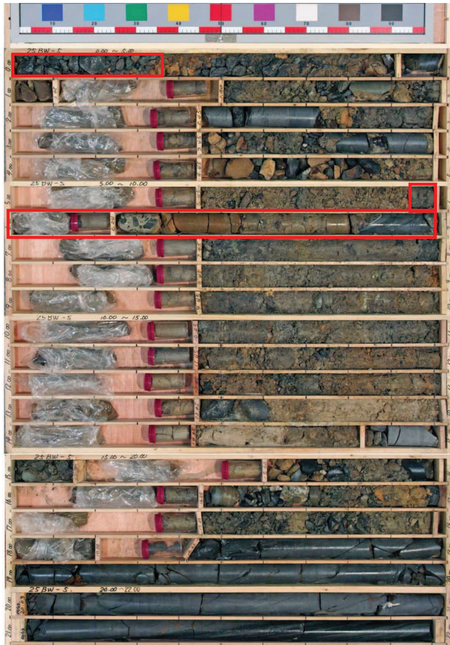
図 1-8(2) ボーリングコア写真 (25BW-5) (盛土: 深度 0~18.20m)
