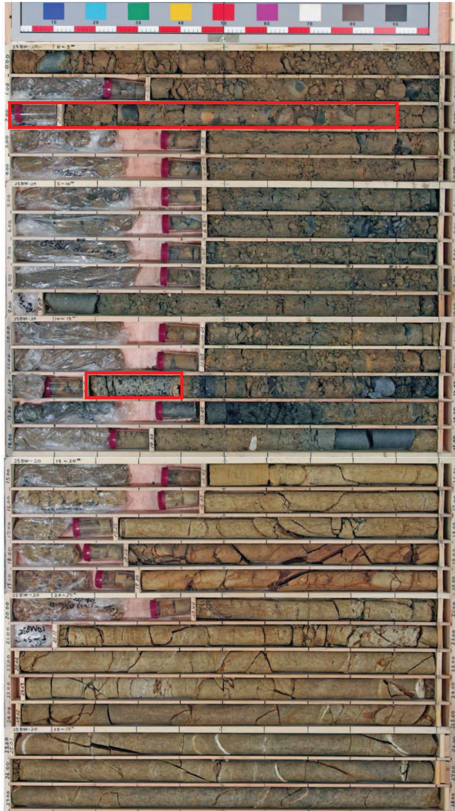
図 1-23(2) ボーリングコア写真 (25BW-20) (盛土：深度 0～13.73m, 旧表土：深度 13.73～15.35m)
