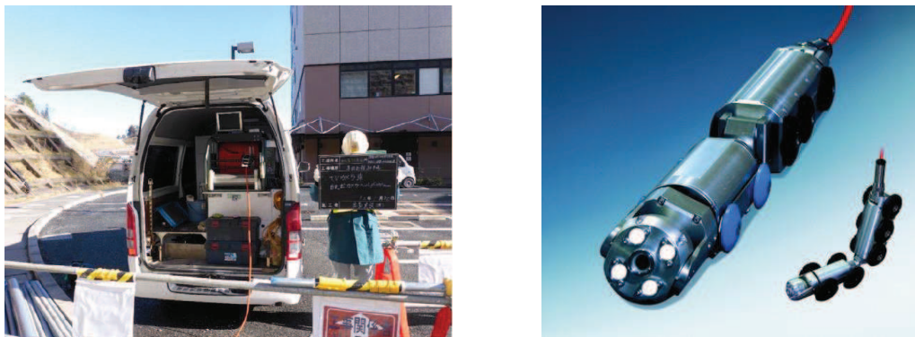
図 9-5 自走式 TV カメラの外観イメージ
