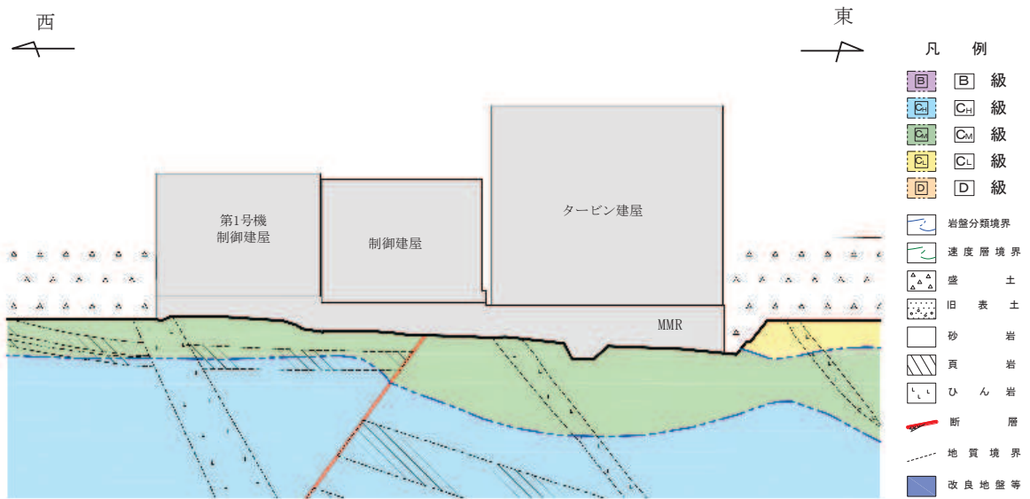
図 3.1-5 制御建屋の地質断面図 (③-③断面)
