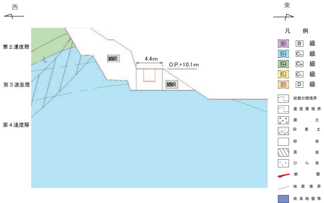
図 3.1-24 揚水井戸の地質断面図 (㉔-㉔断面)
