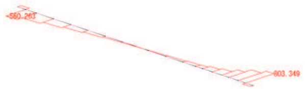
せん断力 Sz 図 角型鋼管 (kN)
