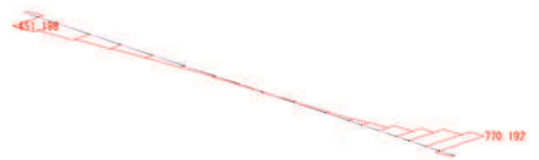
せん断力 S_z 図 角型鋼管
