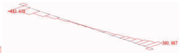
せん断力 S_z 図 角型鋼管
