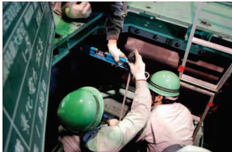
伸び変形量 (枠間距離) 計測状況 (計測値 720mm - 初期値 370 mm * = 伸び 350mm)
