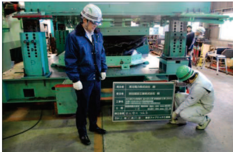
伸び+せん断変形後状況 (伸び 200mm, せん断 350mm)
