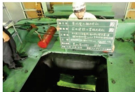
加圧完了 (0.15 MPa, 1 時間保持後, 漏水なし)
