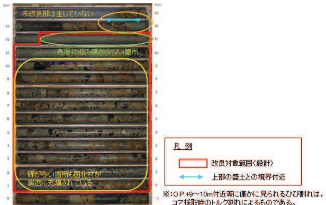
図 6.4-10 ボーリングコア写真（①孔）
