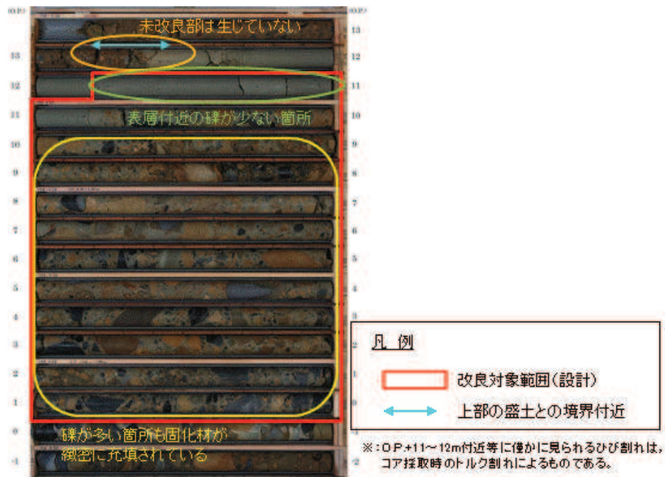
図 6.4-11 ボーリングコア写真 (②孔)
