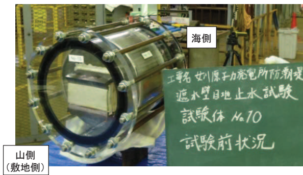
加圧前状況（敷地側）
