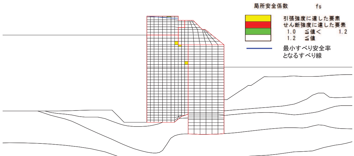
図 3-9 背面補強工の最小すべり安全率時刻における局所安全係数分布 (断面①, ジョイント要素追加設定, S d - D 2 ( - + ) , t=17.48s)
