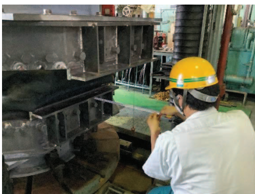
図 6.1.5-12(6) ゴムジョイント変形試験状況（伸び：150mm，せん断：350mm）
