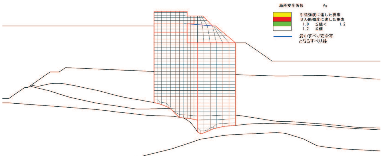
図 5.5-14 セメント改良土のすべり安全率時刻における局所安全係数分布 (断面②, S s - D 2 ( - - ) , t=25.13, 液状化非考慮ケース①)
