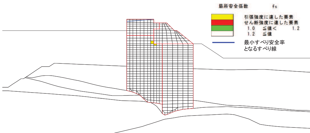
図 4.1-5 (2) 背面補強工の最小すべり安全率時刻における局所安全係数分布 (断面②, S_s - D2 (—), t=6.91s )
