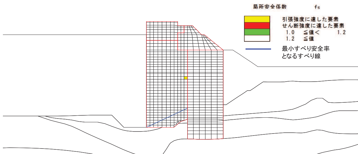
図 3-5 改良地盤の最小すべり安全率時刻における局所安全係数分布 (断面①, 短杭, S_s - D_2 (---), t=25.30s )
