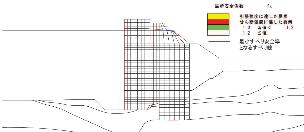
図 3-6 セメント改良土の最小すべり安全率時刻における局所安全係数分布 (断面①, 短杭, S_s - D_2 (---), t=13.48s )
