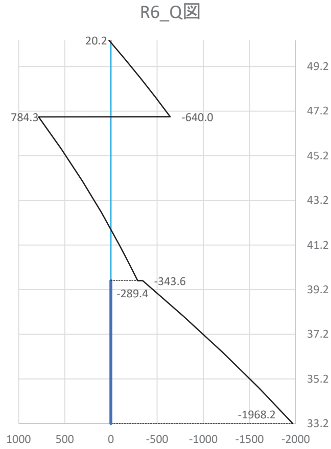
図 3-6 せん断力図 (単位 : kN) (R6 柱)
