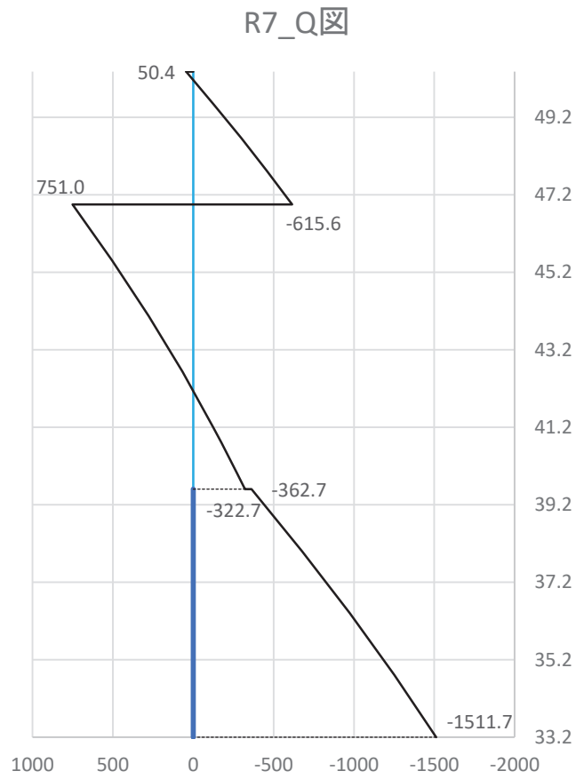
図 3-8 せん断力図 (単位 : kN) (R7 柱)
