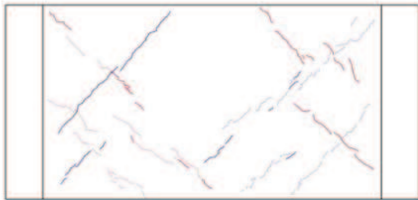
図 3-4(3) 1/2500rad.におけるひび割れ図
