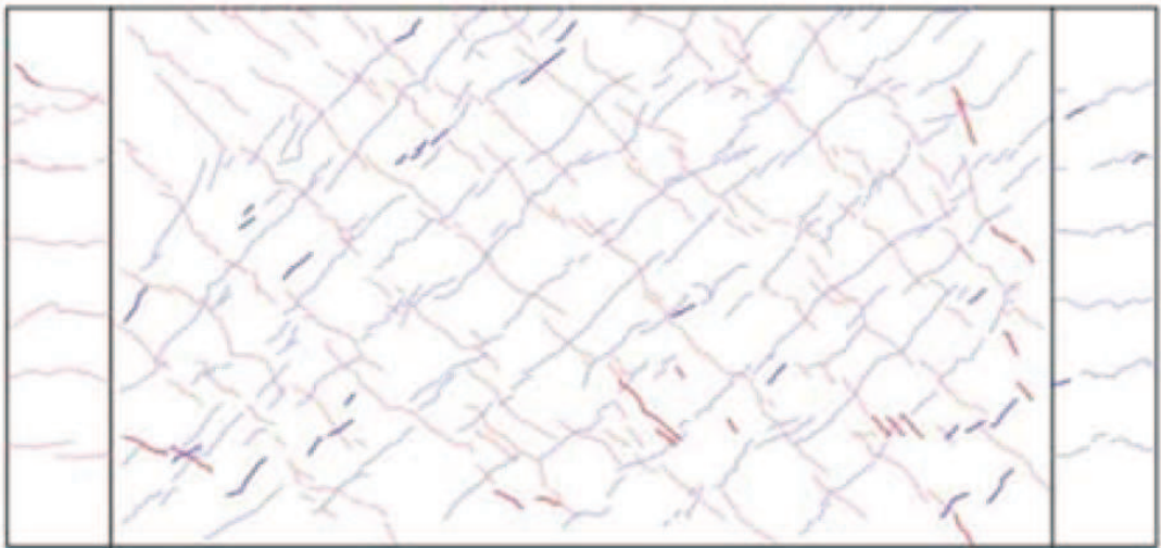
図 3-3 最終破壊時ひび割れ図
