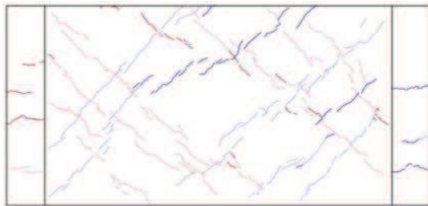
図 3-4(5) 1/1250rad. におけるひび割れ図
