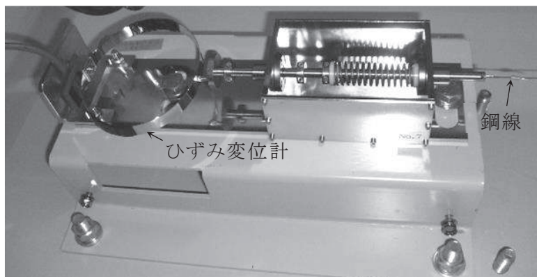
図1-5 変位計及び変位計取付治具の設置状況
