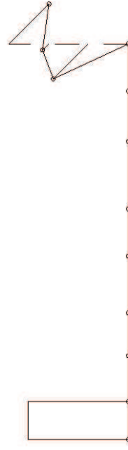
図 3-25 第 3 号機原子炉建屋 固有振動モード (鉛直方向)
