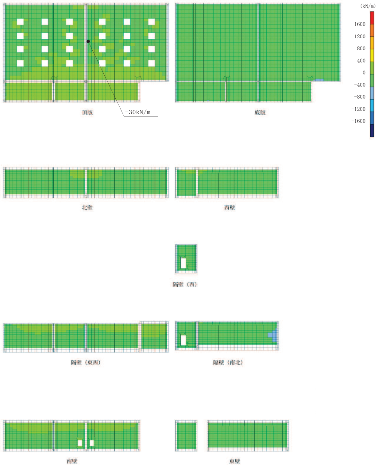
図 10-3 静的地震力載荷時の断面力分布図 (軸力 ( \text{kN/m} ): N_x )
