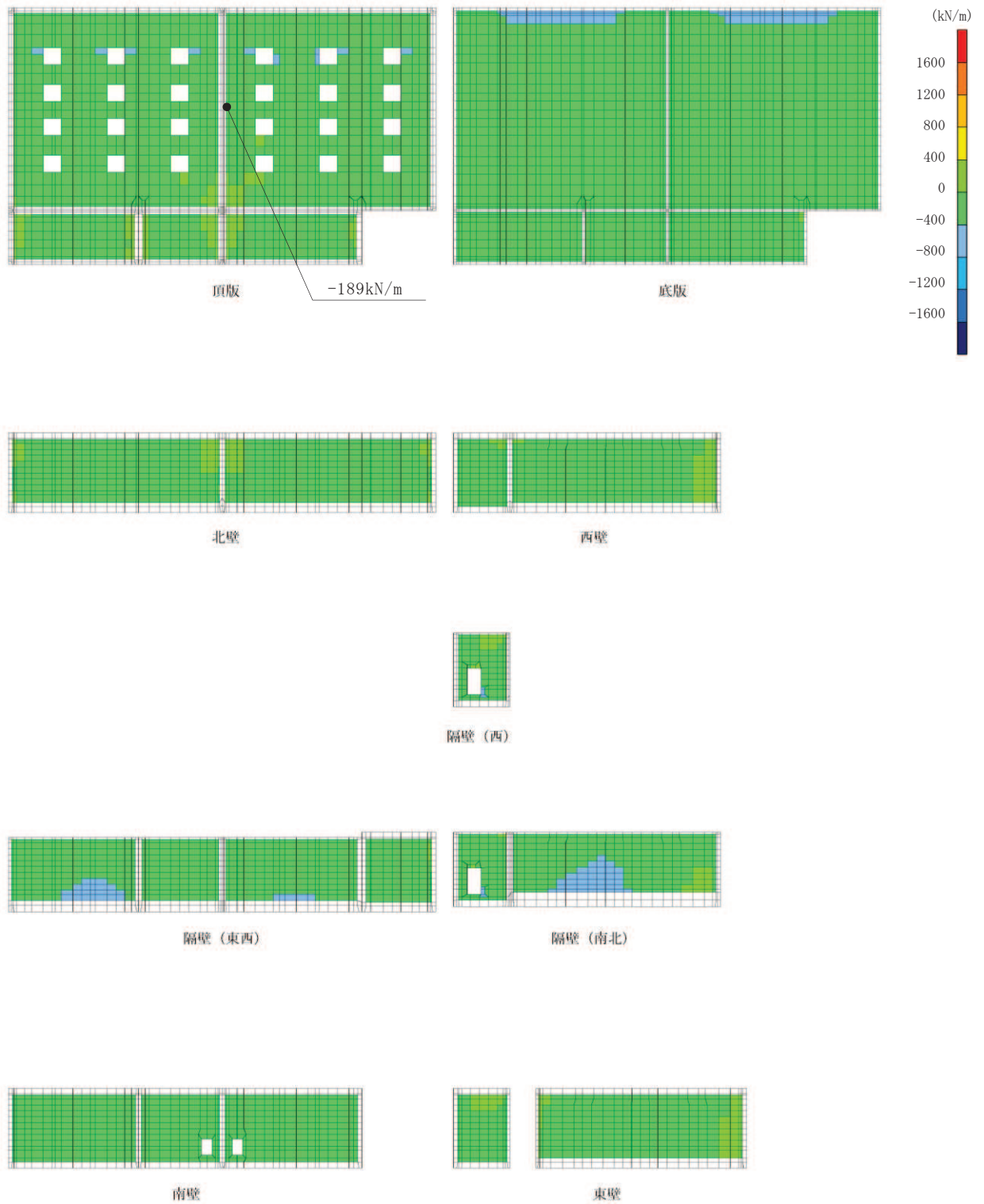
図 10-4 静的地震力載荷時の断面力分布図 (軸力 ( \text{kN/m} ) : N_y )
