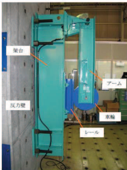
図 1-8 車輪反発係数試験体*
