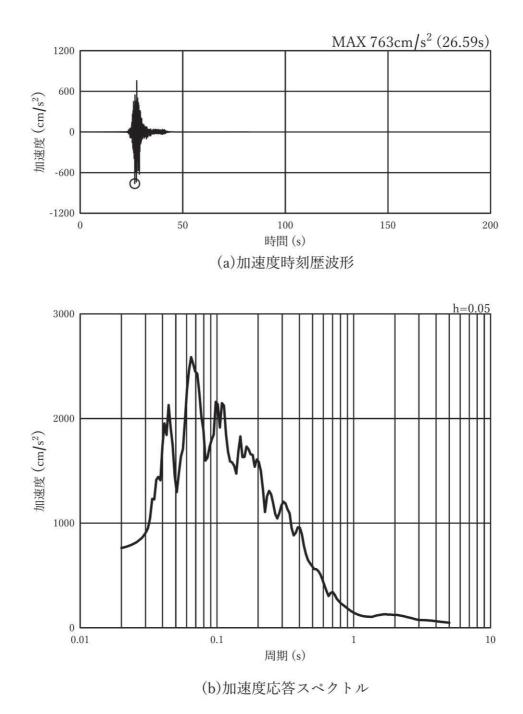
図 3-8(11) 入力地震動の加速度時刻歴波形及び加速度応答スペクトル (水平方向:Ss-F3),第2号機側
