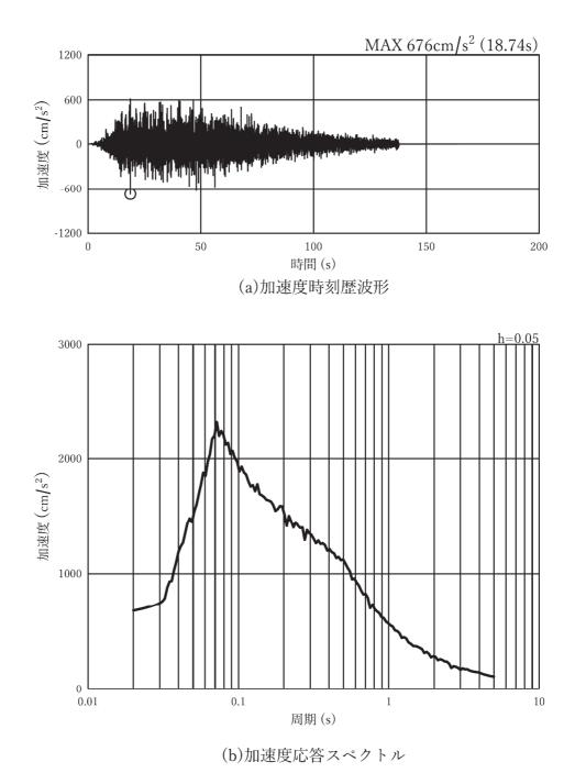
図 3-7(1) 入力地震動の加速度時刻歴波形及び加速度応答スペクトル (水平方向: Ss-D1), 第2号機側
