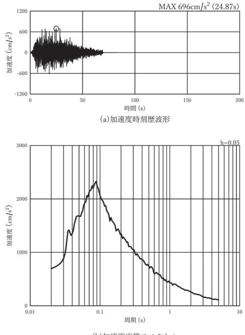
図 3-8(5) 入力地震動の加速度時刻歴波形及び加速度応答スペクトル (水平方向: Ss-D3),第2号機側
