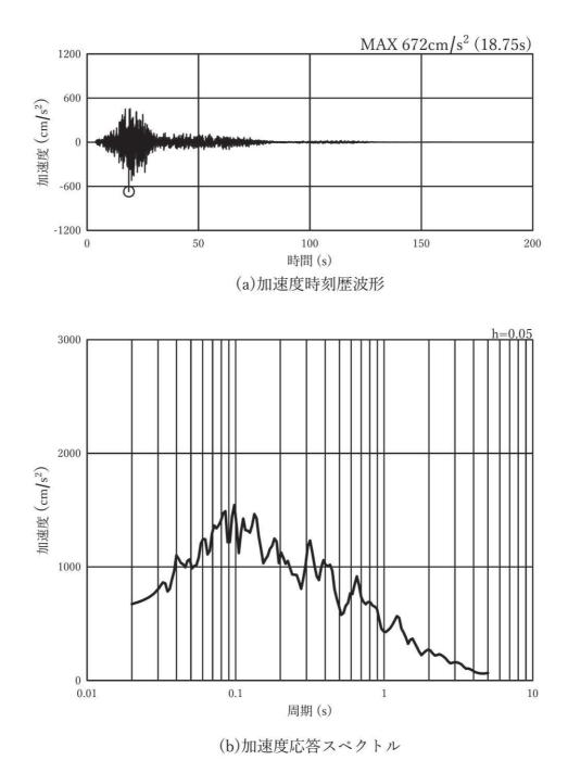
図 3-8(21) 入力地震動の加速度時刻歴波形及び加速度応答スペクトル (水平方向:Ss-F1),第3号機側
