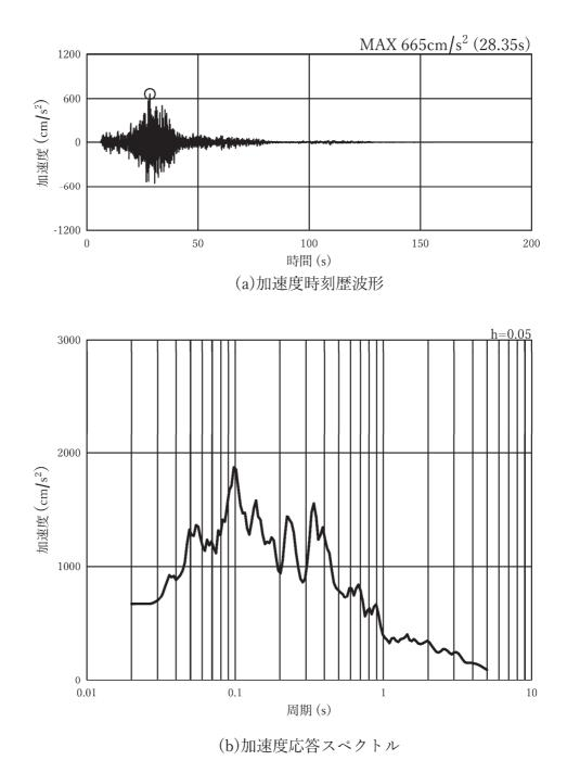
図 3-7(23) 入力地震動の加速度時刻歴波形及び加速度応答スペクトル (水平方向: Ss-F2),第3号機側
