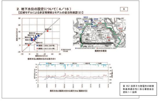
図 2-4 ①広域モデルによる水位側の妥当性確認状況
