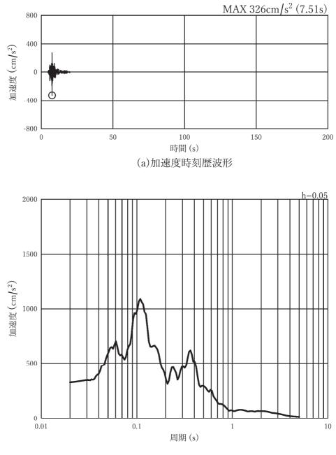
図 3-7(14) 入力地震動の加速度時刻歴波形及び加速度応答スペクトル
