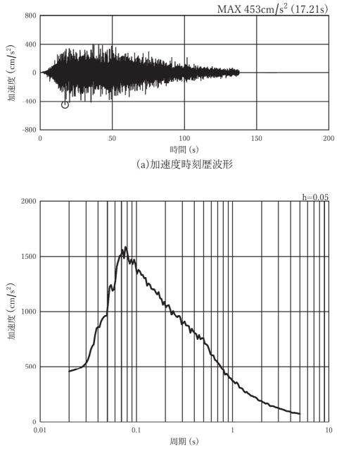
図 3-7(16) 入力地震動の加速度時刻歴波形及び加速度応答スペクトル (鉛直方向: Ss-D1), 第3号機側
