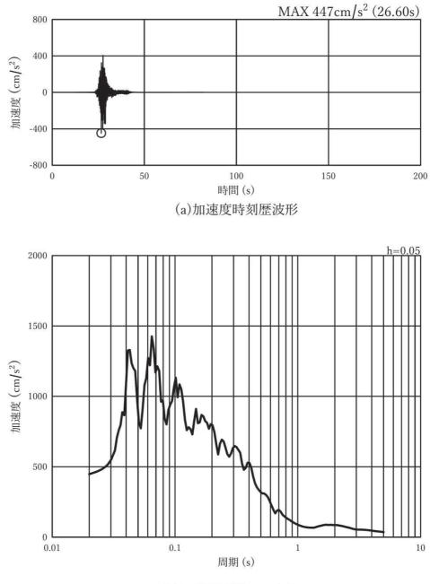
図 3-8(26) 入力地震動の加速度時刻歴波形及び加速度応答スペクトル
