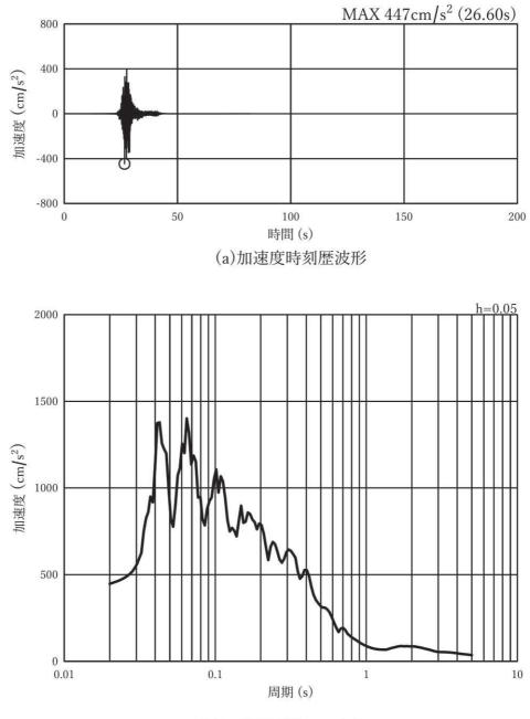
図 3-8(12) 入力地震動の加速度時刻歴波形及び加速度応答スペクトル (鉛直方向:Ss-F3),第2号機側
