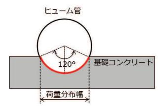
図 3-9 ヒューム管における基礎地盤の接地圧の考え方
