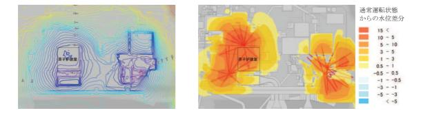
(a)解析水位分布図(b)初期水位からの差分図図 3-3 地下水位の分布(排水機能停止後 25 時間経過)
