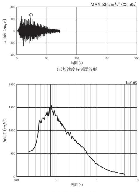
図 3-8(4) 入力地震動の加速度時刻歴波形及び加速度応答スペクトル (鉛直方向:Ss-D2),第2号機側
