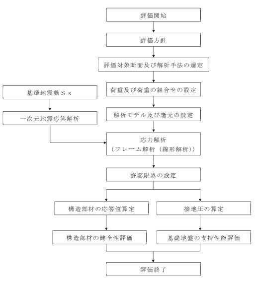
図 2-5 ヒューム管の耐震評価フロー
