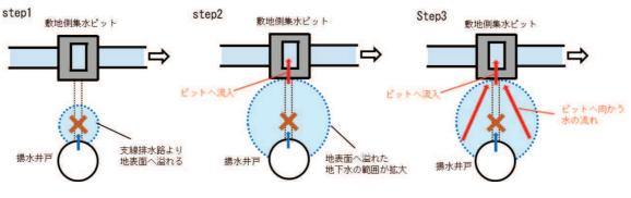
図7 地表面を通じた排水の考え方(平面図)
