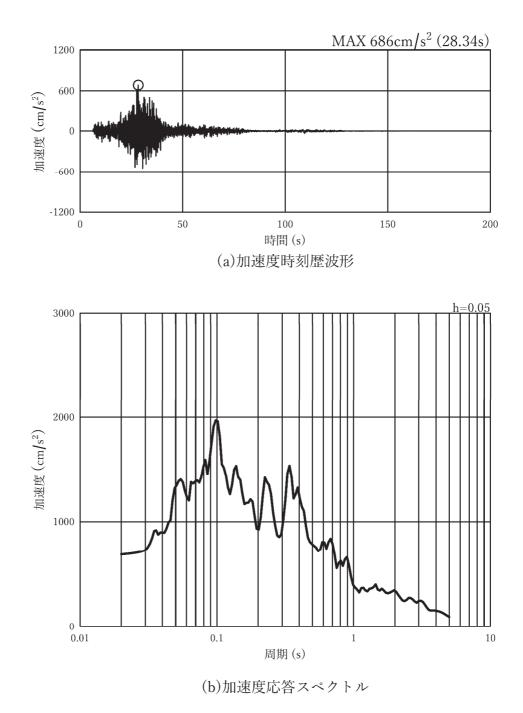
図 3-7(9) 入力地震動の加速度時刻歴波形及び加速度応答スペクトル (水平方向: Ss-F2), 第2号機側
