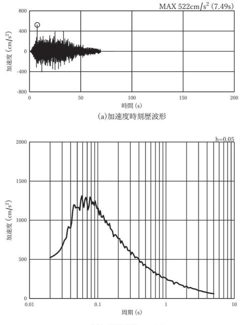
図 3-8(20) 入力地震動の加速度時刻歴波形及び加速度応答スペクトル
