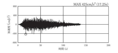
図 4-1(9) 加速度時刻歴波形(断面⑤) (鉛直方向: S s - D 1:地盤物性ケース③)
