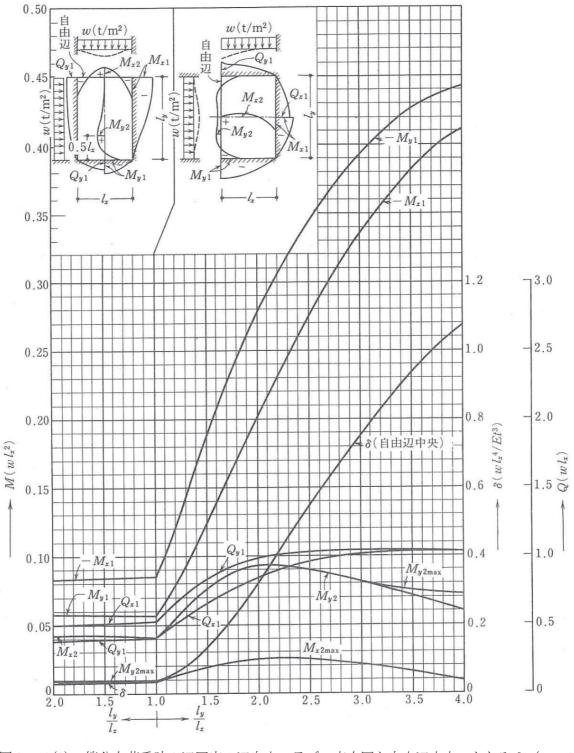
図 3-10(2) 等分布荷重時 3 辺固定 1 辺自由スラブの応力図と自由辺中央のたわみδ (ν=0) (日本建築学会 1991 年 鉄筋コンクリート構造計算規準・同解説)
