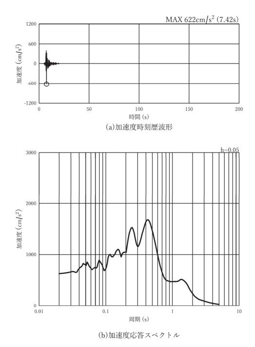
図 3-7(13) 入力地震動の加速度時刻歴波形及び加速度応答スペクトル (水平方向: Ss-N1),第2号機側
