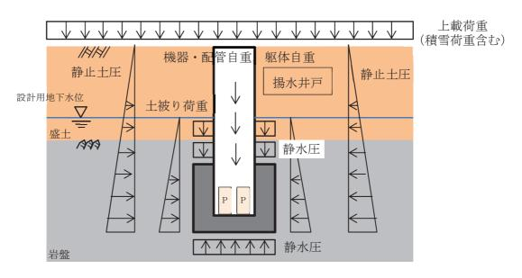
図 3-9 揚水井戸の荷重概要図
