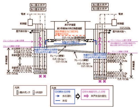
図 3-7 揚水井戸内の水の挙動(概念図)
