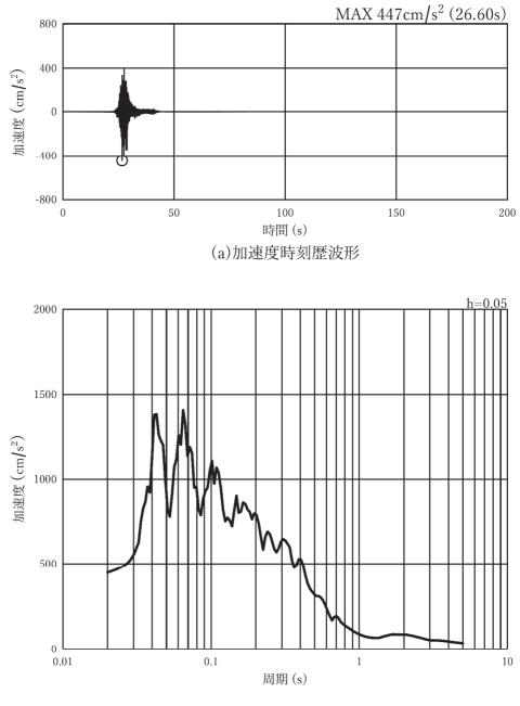
図 3-7(12) 入力地震動の加速度時刻歴波形及び加速度応答スペクトル(鉛直方向:Ss-F3),第2号機側
