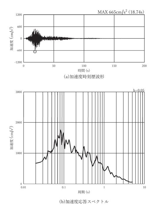
図 3-7(7) 入力地震動の加速度時刻歴波形及び加速度応答スペクトル (水平方向: Ss-F1), 第2号機側
