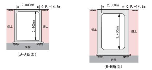
図5 北側・南側幹線排水路の縦断面図(設置変更許可段階)
