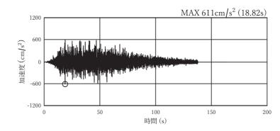
図 4-1(17) 加速度時刻歴波形(接続桝⑨) (水平方向: S s - D 1:解析ケース②)
