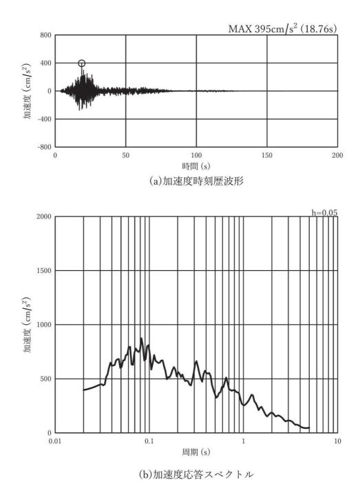
図 3-8(8) 入力地震動の加速度時刻歴波形及び加速度応答スペクトル (鉛直方向:Ss-F1),第2号機側
