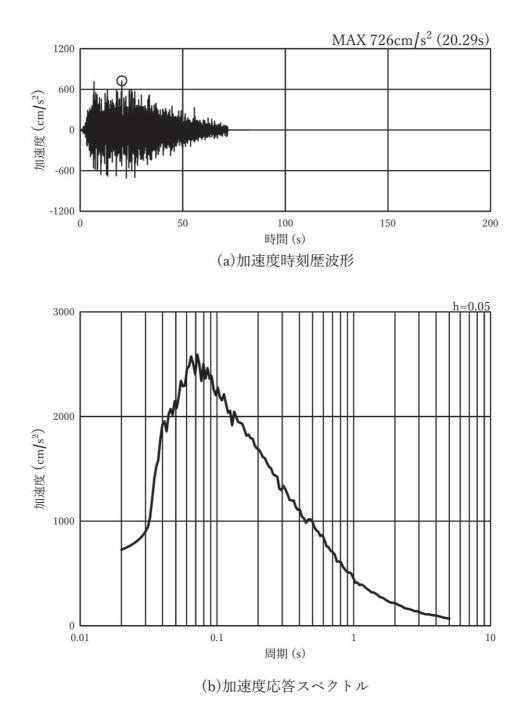
図 3-8(17) 入力地震動の加速度時刻歴波形及び加速度応答スペクトル (水平方向: Ss-D2), 第3号機側
