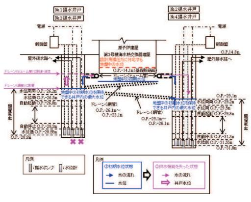
図 3-9 揚水井戸内の水の挙動(概念図)
