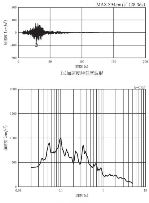
図 3-8(10) 入力地震動の加速度時刻歴波形及び加速度応答スペクトル
