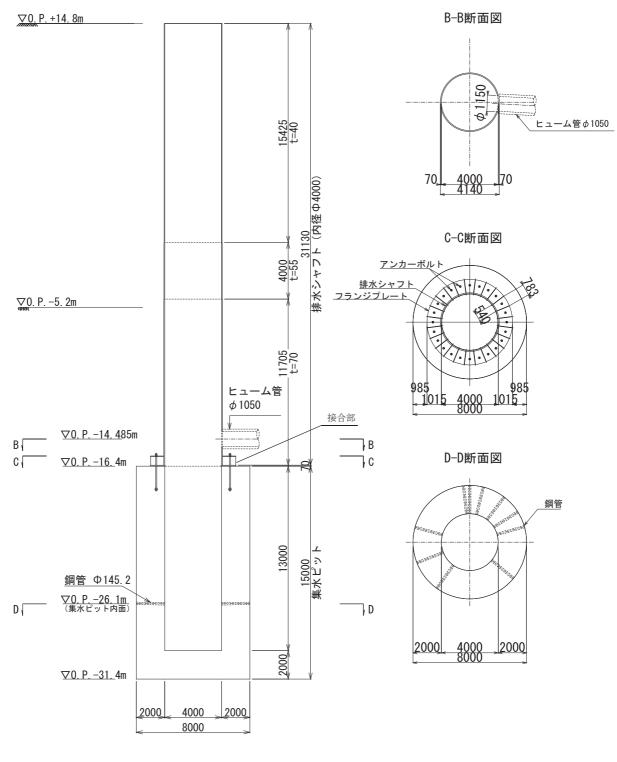
図 2-3(1) No.1 揚水井戸 構造図(単位:mm)
