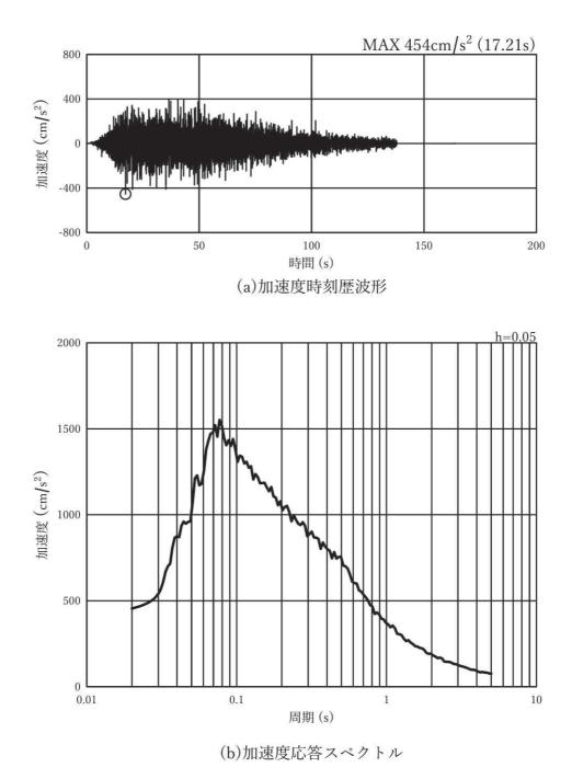
図 3-8(2) 入力地震動の加速度時刻歴波形及び加速度応答スペクトル
