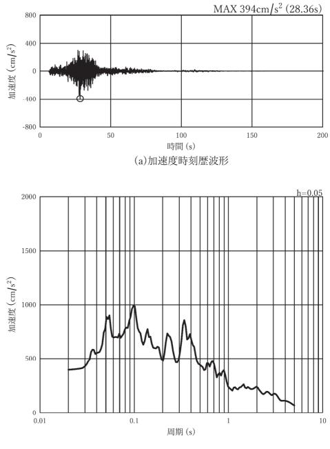
図 3-7(10) 入力地震動の加速度時刻歴波形及び加速度応答スペクトル (鉛直方向: Ss-F2),第2号機側
