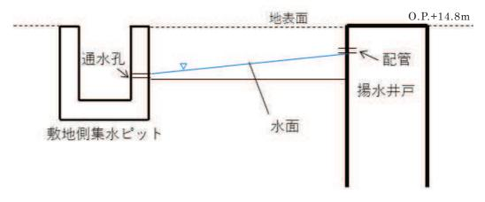
図 10(1) No. 1, 3, 4 揚水井戸~敷地側集水ピットの排水経路概念図
