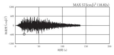
図 4-1(11) 加速度時刻歴波形(接続桝⑥) (水平方向: S s - D 1:解析ケース②)
