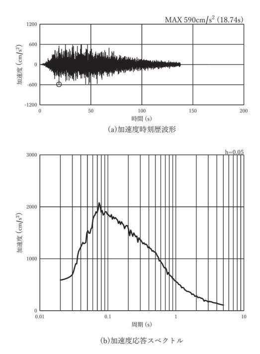
図 3-8(15) 入力地震動の加速度時刻歴波形及び加速度応答スペクトル (水平方向:Ss-D1),第3号機側
