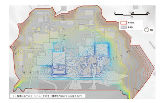
図 3-10 アクセスルート(0.P.+14.8m 盤)の評価において参照する予測解析結果(0.P., m)
