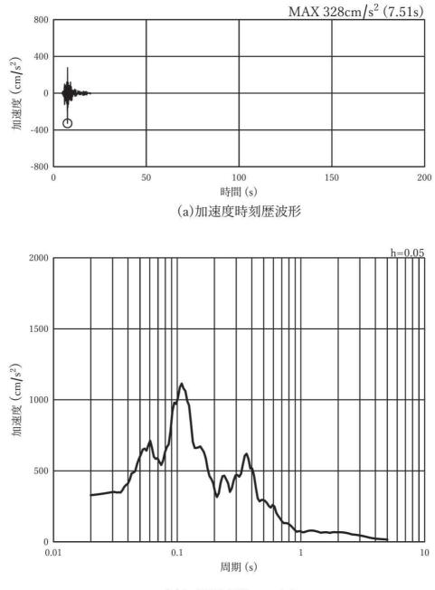
図 3-8(28) 入力地震動の加速度時刻歴波形及び加速度応答スペクトル
