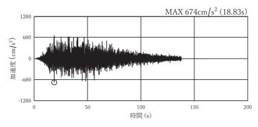
図 4-1(15) 加速度時刻歴波形(接続桝⑧) (水平方向: S s - D 1:解析ケース③)
