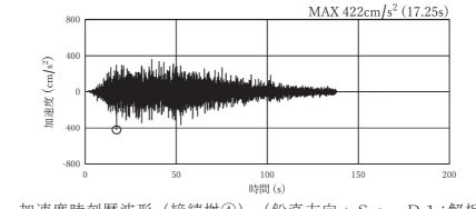
図 4-1(8) 加速度時刻歴波形(接続桝④)(鉛直方向: S s - D 1:解析ケース②)
