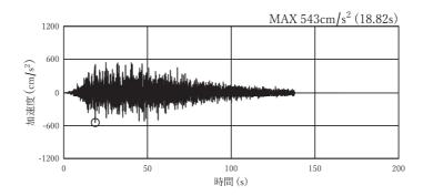
図 4-1(5) 加速度時刻歴波形(接続桝③) (水平方向: S s - D 1:解析ケース②)
