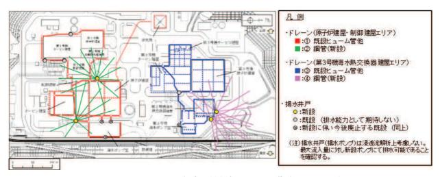
図 2-6 地下水流入量評価における集水エリア区分
