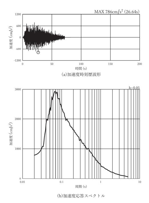
図 3-7(3) 入力地震動の加速度時刻歴波形及び加速度応答スペクトル (水平方向: Ss-D2), 第2号機側
