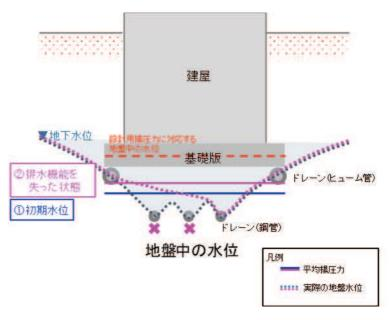
図 3-8 地盤中の地下水位の挙動(概念図)
