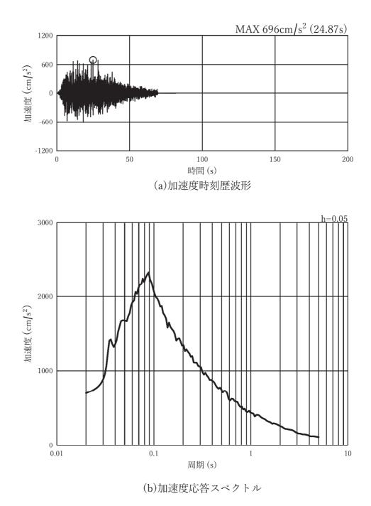
図 3-7(5) 入力地震動の加速度時刻歴波形及び加速度応答スペクトル (水平方向: Ss-D3), 第2号機側
