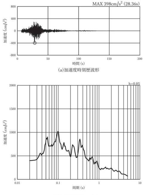
図 3-8(24) 入力地震動の加速度時刻歴波形及び加速度応答スペクトル (鉛直方向:Ss-F2),第3号機側
