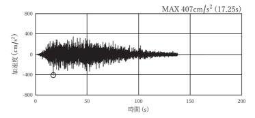
図 4-1(2) 加速度時刻歴波形(接続桝①)(鉛直方向: S s - D 1:解析ケース②)
