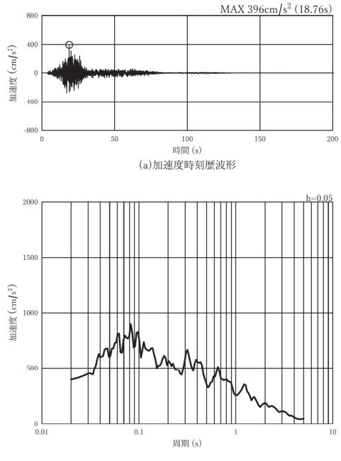
図 3-7(22) 入力地震動の加速度時刻歴波形及び加速度応答スペクトル
