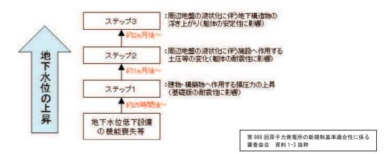
図 3-1 地下水位上昇による耐震性への影響
