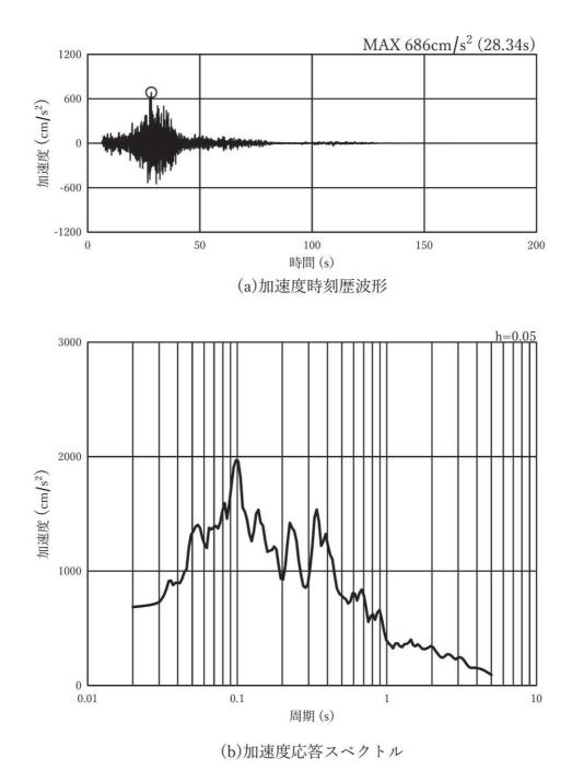
図 3-8(9) 入力地震動の加速度時刻歴波形及び加速度応答スペクトル (水平方向:Ss-F2),第2号機側
