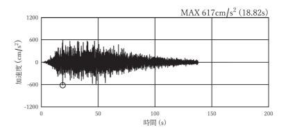
図 4-1(3) 加速度時刻歴波形(接続桝②) (水平方向: S s - D 1:解析ケース②)
