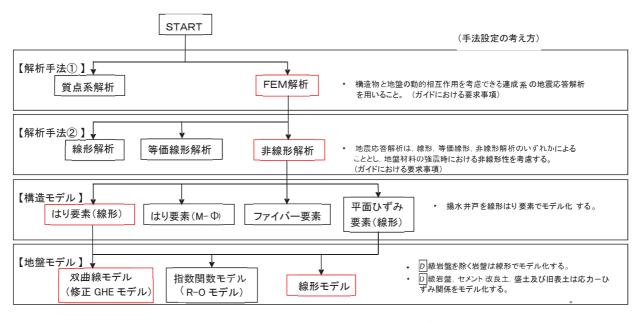
図 3-5 地震応答解析手法における構造・地盤モデルの選定フロー
