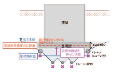
図 3-6 地盤中の地下水位の挙動(概念図)
