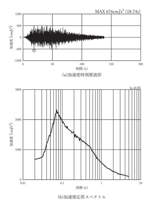
図 3-8(1) 入力地震動の加速度時刻歴波形及び加速度応答スペクトル (水平方向:Ss-D1),第2号機側
