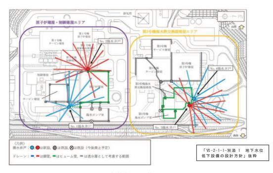
図1 地下水位低下設備の配置
