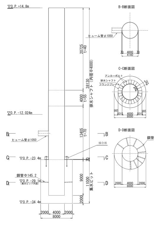
図 2-3(4) No.4 揚水井戸 構造図 (単位:mm)
