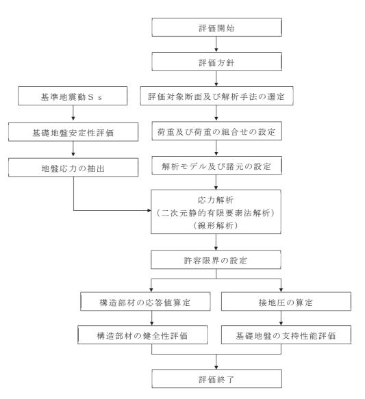
図 2-6 鋼管の耐震評価フロー
