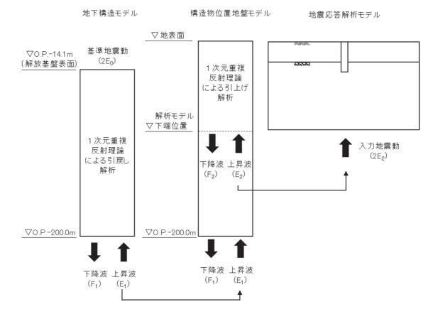
図 3-10 入力地震動算定の概念図
