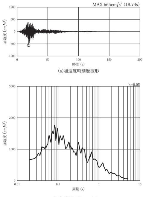
図 3-8(7) 入力地震動の加速度時刻歴波形及び加速度応答スペクトル (水平方向:Ss-F1),第2号機側
