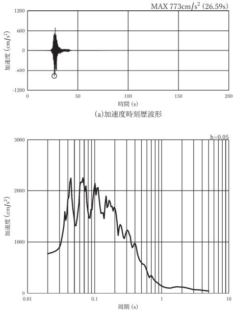
図 3-7(25) 入力地震動の加速度時刻歴波形及び加速度応答スペクトル (水平方向: Ss-F3), 第3号機側
