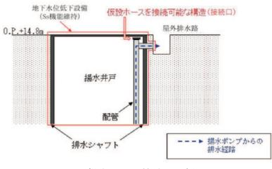
図 14 揚水井戸 接続口の概要図
