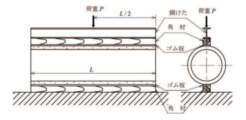
図2 外圧試験概要図
