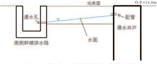
図 10(2) No.2 揚水井戸~南側幹線排水路の排水経路概念図
