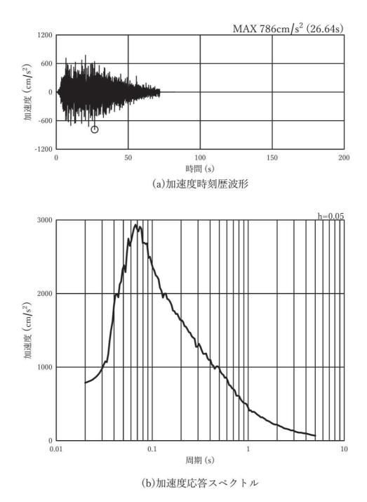
図 3-8(3) 入力地震動の加速度時刻歴波形及び加速度応答スペクトル (水平方向: Ss-D2), 第2号機側
