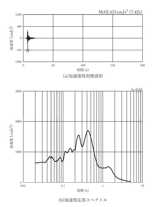
図 3-7(27) 入力地震動の加速度時刻歴波形及び加速度応答スペクトル (水平方向: Ss-N1),第3号機側
