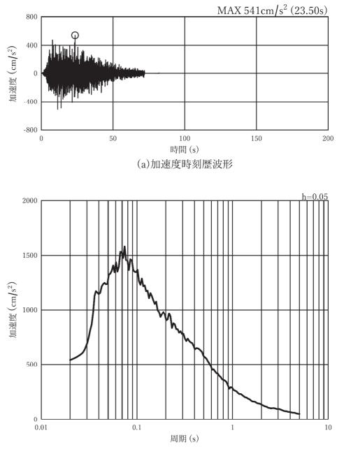
図 3-7(18) 入力地震動の加速度時刻歴波形及び加速度応答スペクトル (鉛直方向: Ss-D2), 第3号機側
