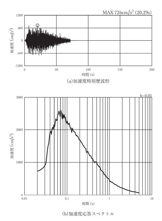
図 3-7(17) 入力地震動の加速度時刻歴波形及び加速度応答スペクトル (水平方向: Ss-D2),第3号機側
