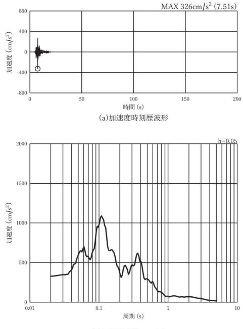
図 3-8(14) 入力地震動の加速度時刻歴波形及び加速度応答スペクトル
