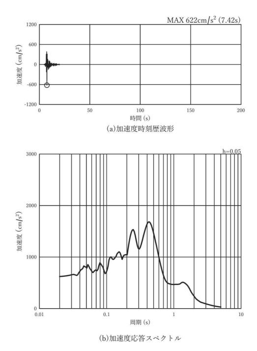
図 3-8(13) 入力地震動の加速度時刻歴波形及び加速度応答スペクトル (水平方向:Ss-N1),第2号機側
