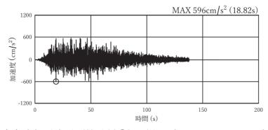
図 4-1(7) 加速度時刻歴波形(接続桝④) (水平方向: S s - D 1:解析ケース②)
