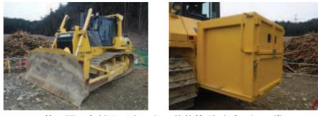
第2図 角材及び土のうの積載箇所(ブルドーザ)
