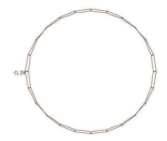
図 4-2(4) 曲げモーメント図 (断面④ (φ500mm, 3種), Ss-D1, t=35.23秒) (解析ケース:ケース③)
