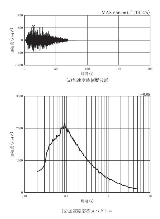
図 3-8(19) 入力地震動の加速度時刻歴波形及び加速度応答スペクトル (水平方向: Ss-D3), 第3号機側
