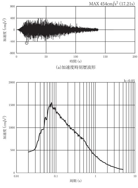
図 3-7(2) 入力地震動の加速度時刻歴波形及び加速度応答スペクトル (鉛直方向: Ss-D1), 第2号機側
