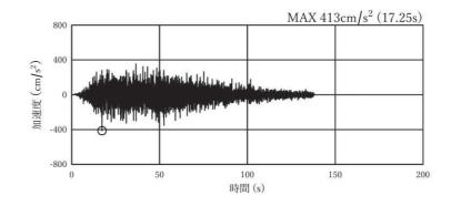
図 4-1(5) 加速度時刻歴波形(断面③) (鉛直方向: S s - D 1:地盤物性ケース②)
