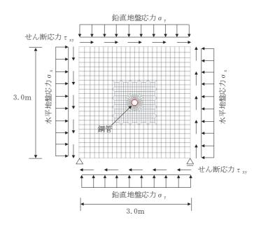
図 3-5 鋼管の解析モデル\* 注記\*:上記荷重の他,常時荷重として躯体自重,地震時 荷重として躯体慣性力を考慮する。
