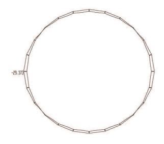
図 4-2(5) 曲げモーメント図 (断面⑤ (φ800mm, 2種), Ss-D1, t=17.25秒) (解析ケース:ケース③)
