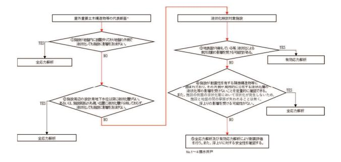
図 3-4 解析手法の選定フロー
