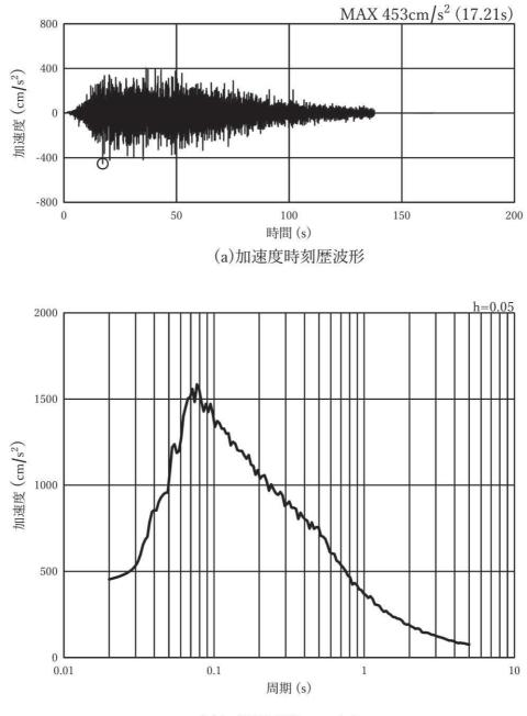
図 3-8(16) 入力地震動の加速度時刻歴波形及び加速度応答スペクトル
