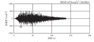
図 4-1(4) 加速度時刻歴波形(断面②) (水平方向: S s - D 1:地盤物性ケース②)
