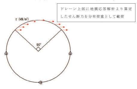
図2 ヒューム管へのせん断力載荷概要図
