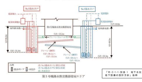
図2 地下水位低下設備の系統構成
