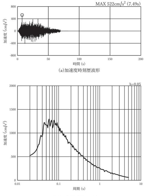
図 3-8(6) 入力地震動の加速度時刻歴波形及び加速度応答スペクトル (鉛直方向:Ss-D3),第2号機側
