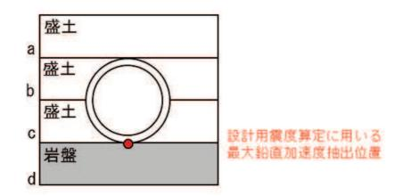
図1 地震応答解析モデル図
