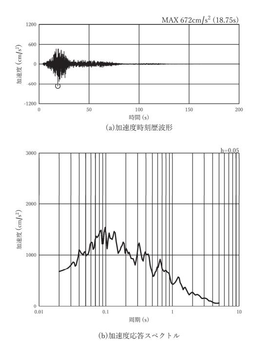
図 3-7(21) 入力地震動の加速度時刻歴波形及び加速度応答スペクトル (水平方向: Ss-F1),第3号機側
