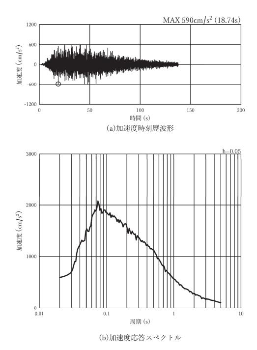
図 3-7(15) 入力地震動の加速度時刻歴波形及び加速度応答スペクトル (水平方向: Ss-D1), 第3号機側
