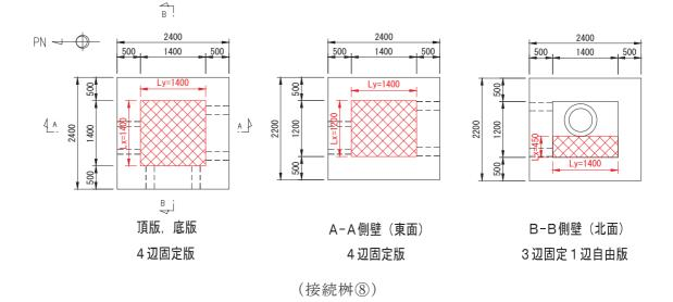
図 3-8(4) 接続桝の解析モデル(Lx:短辺,Ly:長辺)(単位:mm)
