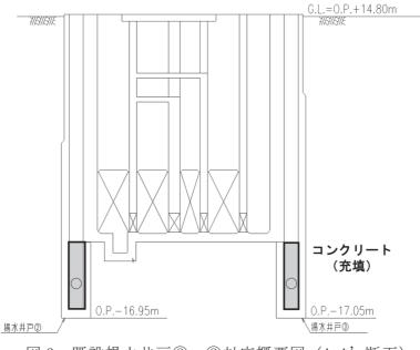
図 3 既設揚水井戸② · ③対応概要図 (A-A'断面)
