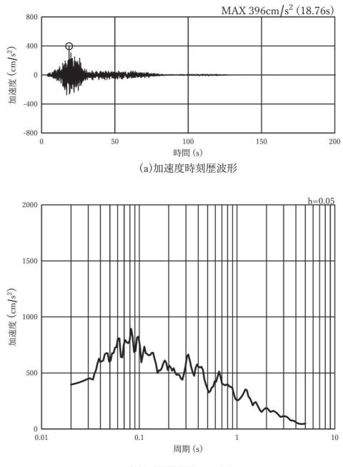
図 3-8(22) 入力地震動の加速度時刻歴波形及び加速度応答スペクトル (鉛直方向:Ss-F1),第3号機側
