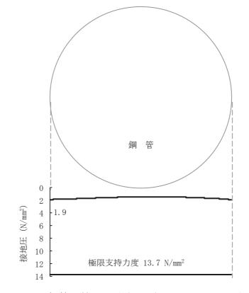
図 4-4 鋼管の接地圧分布図 (Ss-N1, EW 断面)
