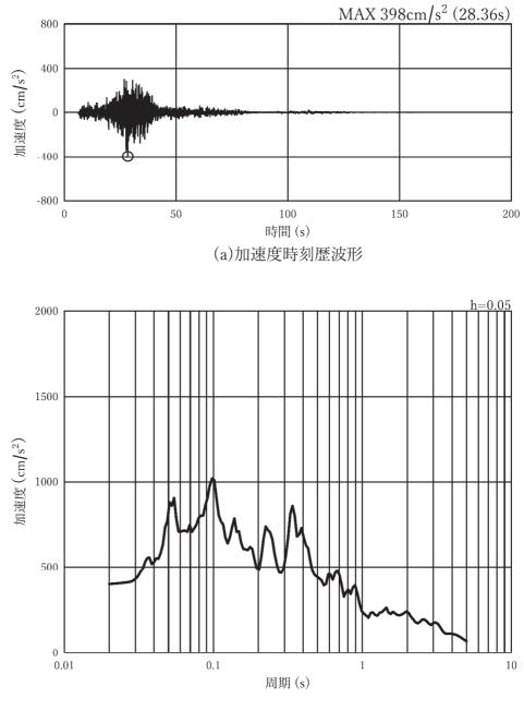
図 3-7(24) 入力地震動の加速度時刻歴波形及び加速度応答スペクトル (鉛直方向:Ss-F2),第3号機側
