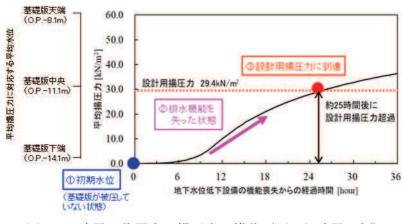
図 3-5 建屋に作用する揚圧力の推移(原子炉建屋の例)
