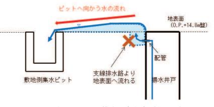
図8 地表面を通じた排水の考え方(断面図)
