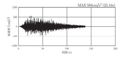
図 4-1(13) 加速度時刻歴波形(接続桝⑦) (水平方向: S s - D 1:解析ケース③)
