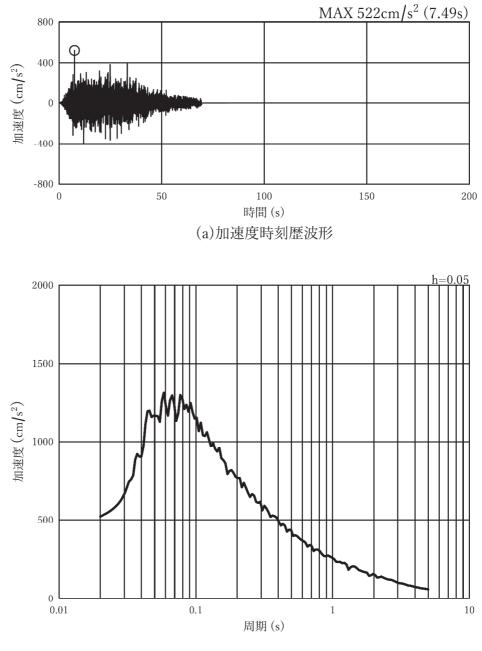
図 3-7(20) 入力地震動の加速度時刻歴波形及び加速度応答スペクトル (鉛直方向: Ss-D3), 第3号機側
