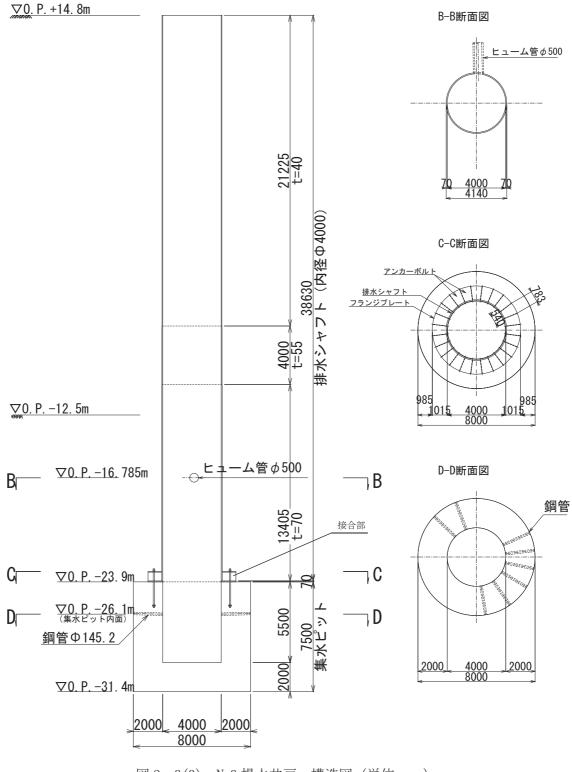
図 2-3(3) No.3 揚水井戸 構造図(単位:mm)
