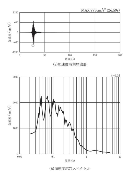
図 3-8(25) 入力地震動の加速度時刻歴波形及び加速度応答スペクトル (水平方向:Ss-F3),第3号機側
