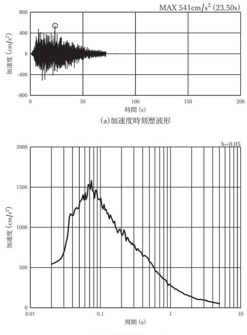
図 3-8(18) 入力地震動の加速度時刻歴波形及び加速度応答スペクトル
