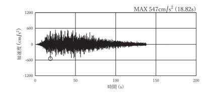
図 4-1(1) 加速度時刻歴波形(接続桝①) (水平方向: S s - D 1:解析ケース②)
