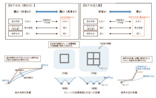
図 1-2 浸透流解析の目的に応じた条件設定例及び浸透流解析条件と評価への影響
