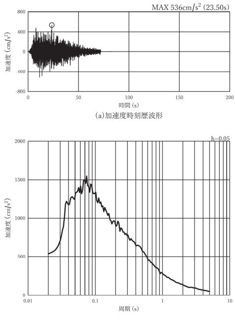
図 3-7(4) 入力地震動の加速度時刻歴波形及び加速度応答スペクトル (鉛直方向: Ss-D2), 第2号機側
