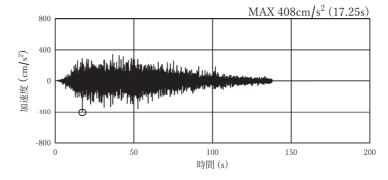
図 4-1(18) 加速度時刻歴波形(接続桝⑨) (鉛直方向: S s - D 1:解析ケース②)
