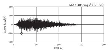
図 4-1(6) 加速度時刻歴波形(接続桝③) (鉛直方向: S s - D 1:解析ケース②)
