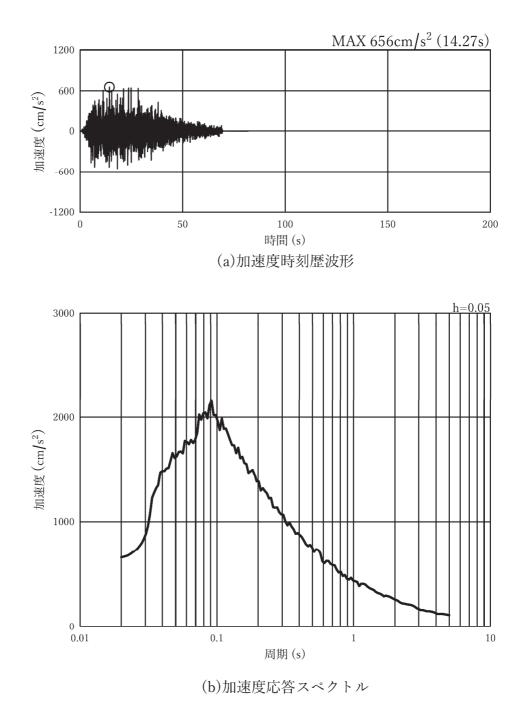
図 3-7(19) 入力地震動の加速度時刻歴波形及び加速度応答スペクトル (水平方向: Ss-D3), 第3号機側
