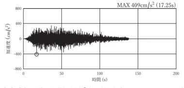
図 4-1(12) 加速度時刻歴波形(接続桝⑥)(鉛直方向: S s - D 1:解析ケース②)
