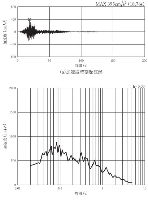
図 3-7(8) 入力地震動の加速度時刻歴波形及び加速度応答スペクトル (鉛直方向:Ss-F1),第2号機側
