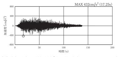
図 4-1(16) 加速度時刻歴波形(接続桝⑧) (鉛直方向: S s - D 1:解析ケース③)
