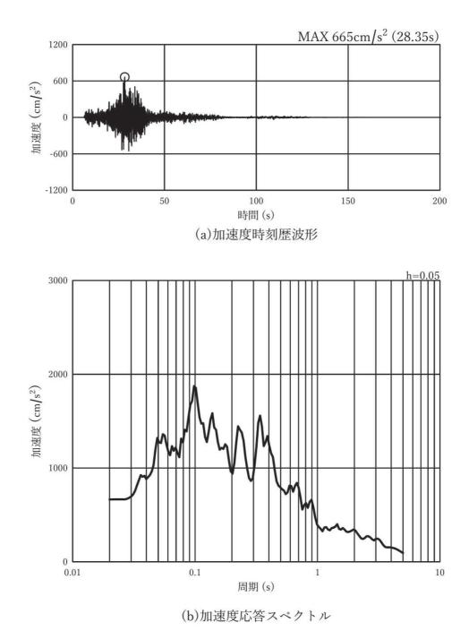
図 3-8(23) 入力地震動の加速度時刻歴波形及び加速度応答スペクトル (水平方向:Ss-F2),第3号機側
