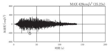
図 4-1(14) 加速度時刻歴波形(接続桝⑦)(鉛直方向: S s - D 1:解析ケース③)
