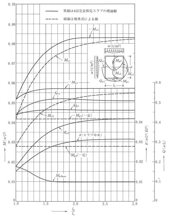
図 3-10(1) 等分布荷重時 4 辺固定スラブの応力図と中央点のたわみδ (ν=0) (日本建築学会 1991 年 鉄筋コンクリート構造計算規準・同解説))
