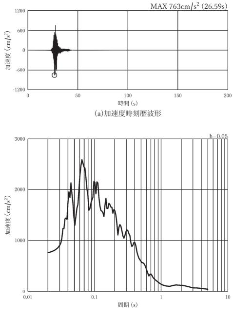
図 3-7(11) 入力地震動の加速度時刻歴波形及び加速度応答スペクトル (水平方向: Ss-F3),第2号機側
