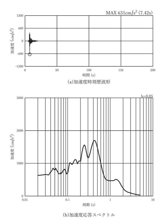
図 3-8(27) 入力地震動の加速度時刻歴波形及び加速度応答スペクトル (水平方向: Ss-N1), 第3号機側
