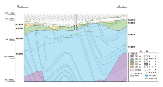
図 3-3(3) №3 揚水井戸 評価対象断面図 (C'-C 断面)
