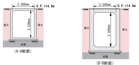
図1-3 北側・南側幹線排水路の断面図(本編図5再掲)
