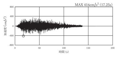
図 4-1(10) 加速度時刻歴波形(接続桝⑤)(鉛直方向: S s - D 1:解析ケース②)
