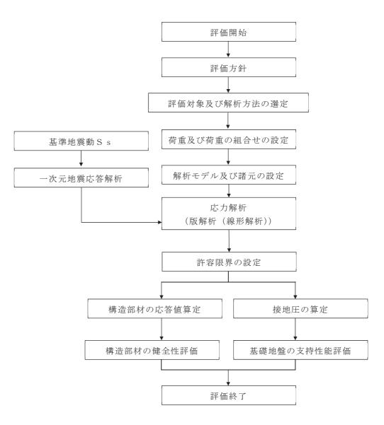
図 2-3 接続桝の評価フロー
