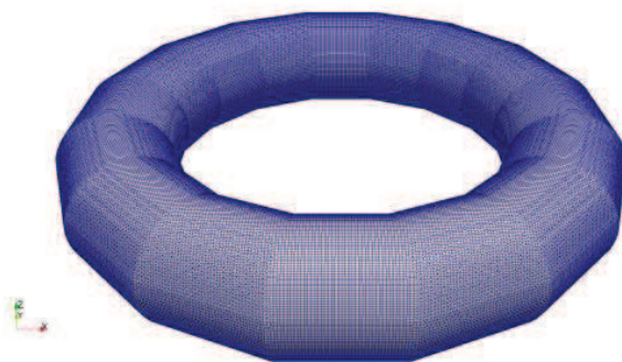
図 17 流体解析モデル（試験体解析モデル）
