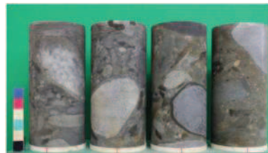
液状化強度試験供試体 (A-6 : 試験前)
