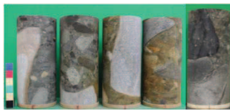
液状化強度試験供試体 (A-7-2 : 試験前)
