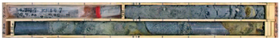
ボーリングコア写真(28QB-7 : 7.00m~9.00m)
