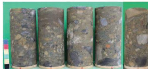
液状化強度試験供試体 (A-2 : 試験前)
