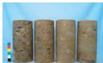
液状化強度試験供試体 (A-4 : 試験前)
