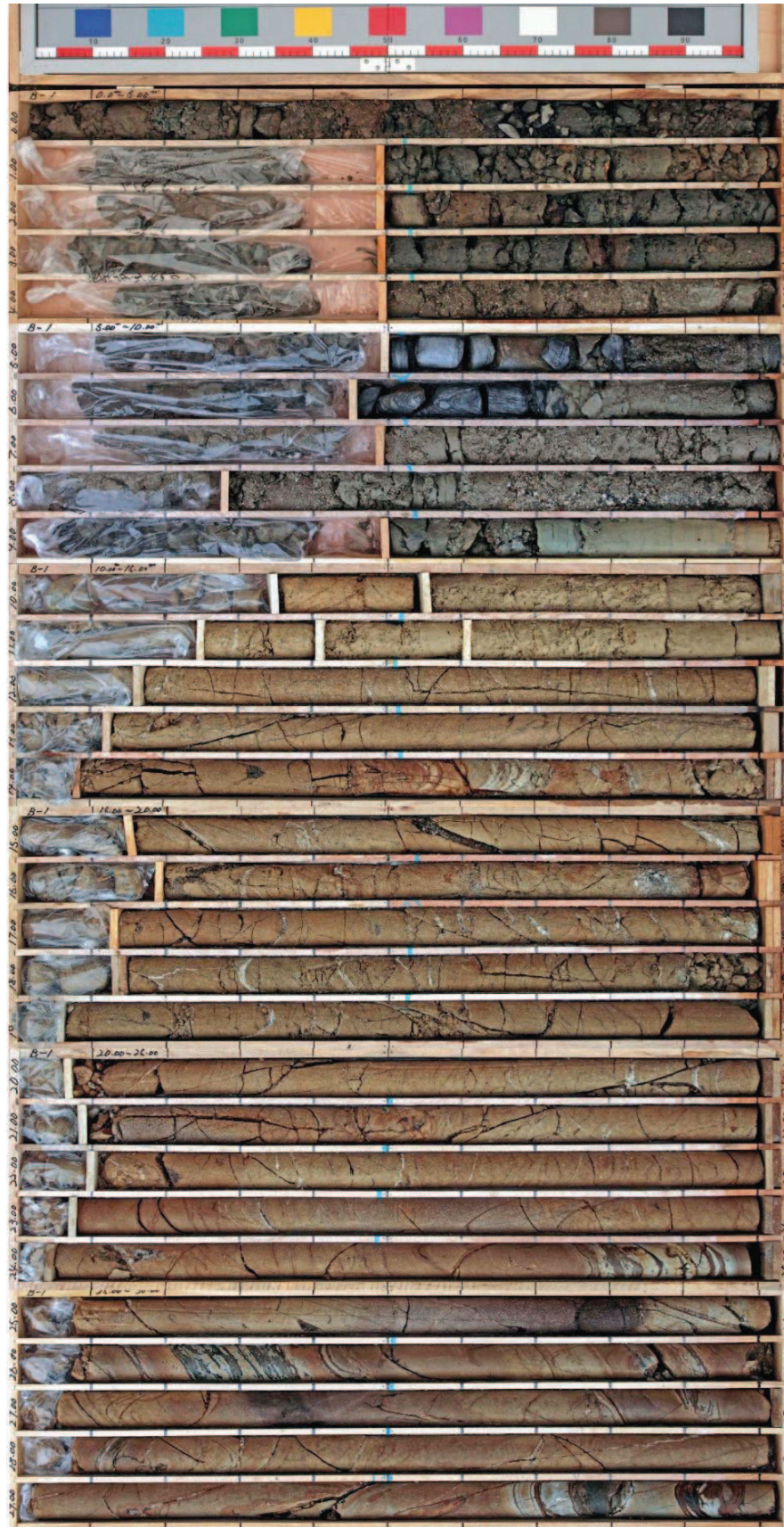
図 1-47(2) ボーリングコア写真 (23B-1) (盛土：深度 0～6.70m, 旧表土：深度 6.70～12.00m)
