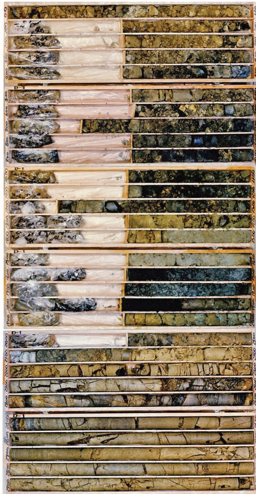
図1-44(2) ボーリングコア写真 (D-1) (盛土：深度0～13.00m, 旧表土：深度13.00～21.40m)
