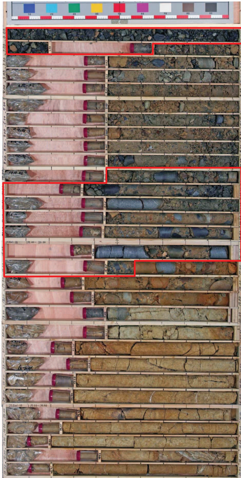
図 1-21(2) ボーリングコア写真 (25BW-18) (盛土：深度 0～16.56m, 旧表土：深度 16.56～19.55m)
