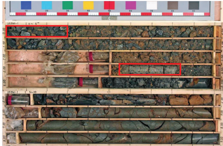
図 1-6(2) ボーリングコア写真 (25BW-1) (盛土：深度 0～4.90m)
