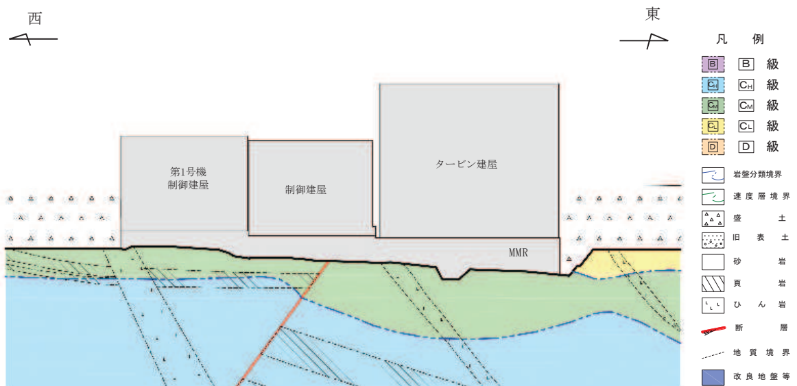
図 3.1-5 制御建屋の地質断面図 (③-③断面)
