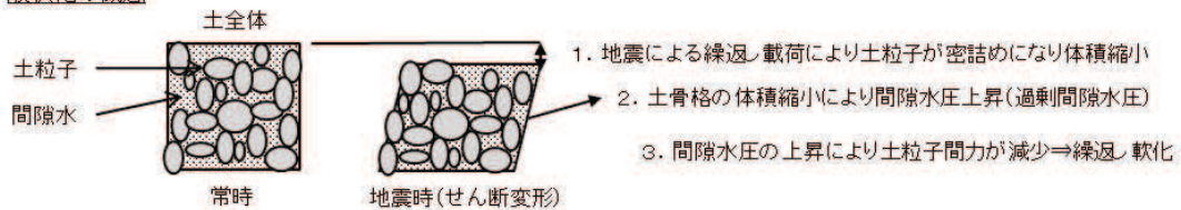
図 3.4-15 液状化の概念図
